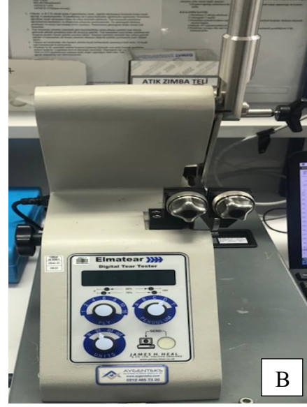
Şekil 3.9. Kopma mukavemeti ve yırtılma mukavemeti test metotlarında kullanılan cihazlar A) Kopma mukavemeti test cihazı B) Yırtılma mukavemeti test cihazı
