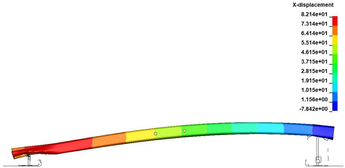
EK 17. Çarpışma sönümleyici grup 3 X eksen yer değıştirme değeri
