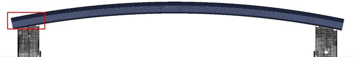
Şekil 3.7.6.3 Çarpışma sönümleyici grubu 2 ağ yapısı
