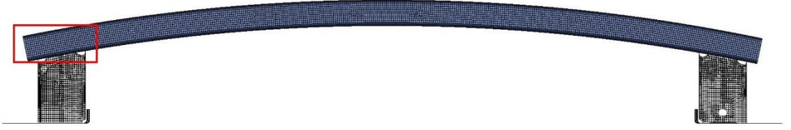
Şekil 3.7.6.5 Çarpışma sönümleyici grubu 3 ağ yapısı
