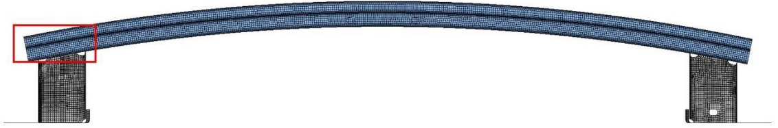
Şekil 3.7.6.9 Çarpışma sönümleyici grubu 5 ağ yapısı
