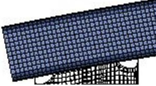
Şekil 3.7.6.6 Tampon kirişi kesiti 3 ağ yapısı
