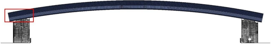
Şekil 3.7.6.7 Çarpışma sönümleyici grubu 4 ağ yapısı
