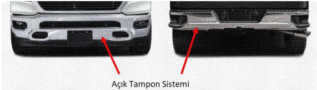
Şekil 1.6. Açık tampon sistemi (Anonim 2020).
