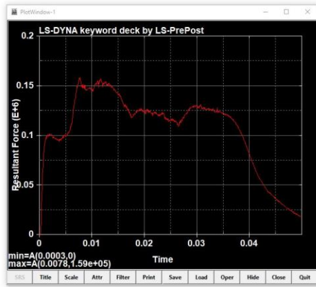
EK 16. Çarpışma sönümleyici grup 3 araç şasisine aktarılan kuvvet değeri
