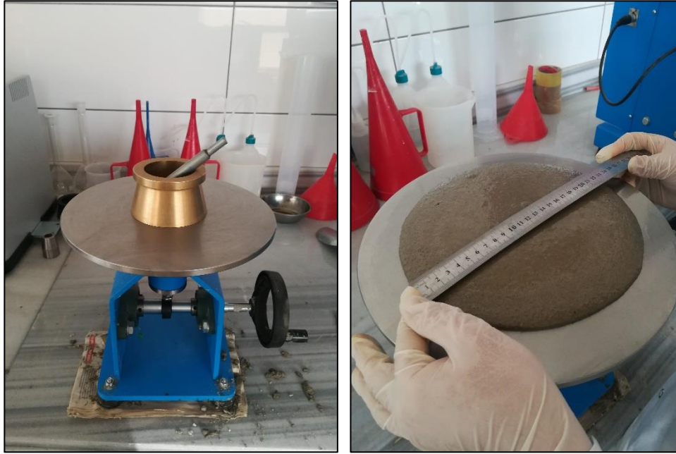
Şekil 3.13. Zamana bağlı yayılma deneyi
