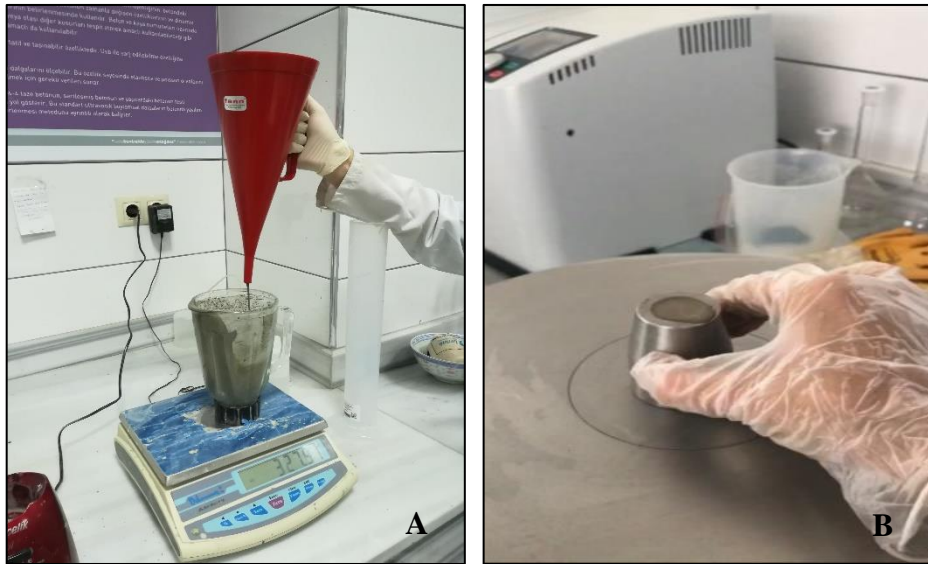
Şekil 3.10. Marsh-hunisi ve mini-yayımla deneyleri. A) Marsh-hunisi B) Mini-çökme
