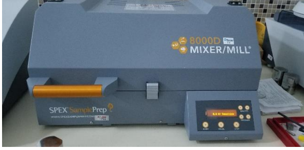
Şekil 3.5. Spex marka yüksek enerjili bilyeli değirmen
