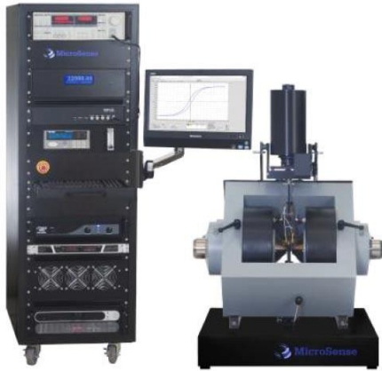
Şekil 3.13. MicroSence marka VSM - Titreşimli Numune Manyetometresi (“VSM”, 2021)
