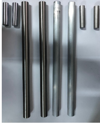
Şekil 3.12. SAE 304 ve AL 6082 çekme test numuneleri
