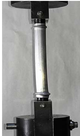
Şekil 4.29. L_k = L mesnetlenme durumunda N.61 numunesinin yükleme sonrası görüntüsü
