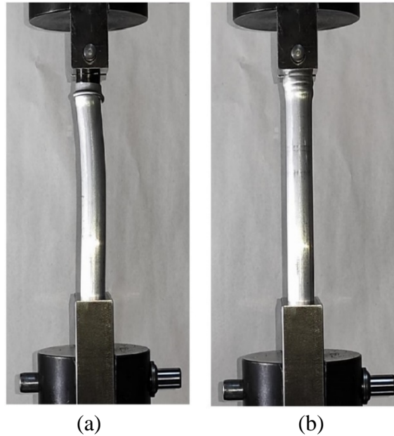
Şekil 4.11. L_k=0,7 L mesnetlenme durumunda numunelerin yükleme sonrası görüntüleri a) N.61 numunesi, b) N.62 numunesi
