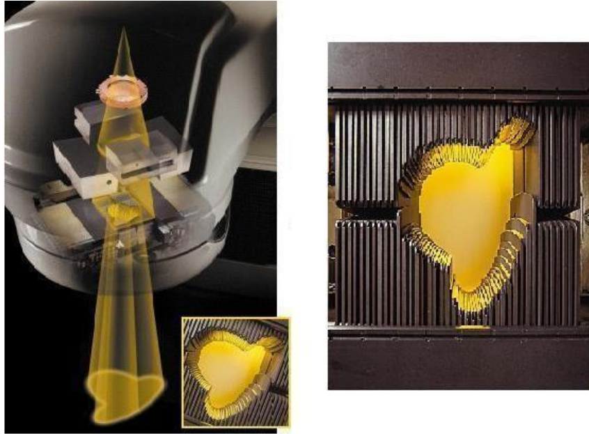
Şekil 13: Çok yapraklı kolimatörde bir lifin şematik gösterimi (Altındaş, 2021).
