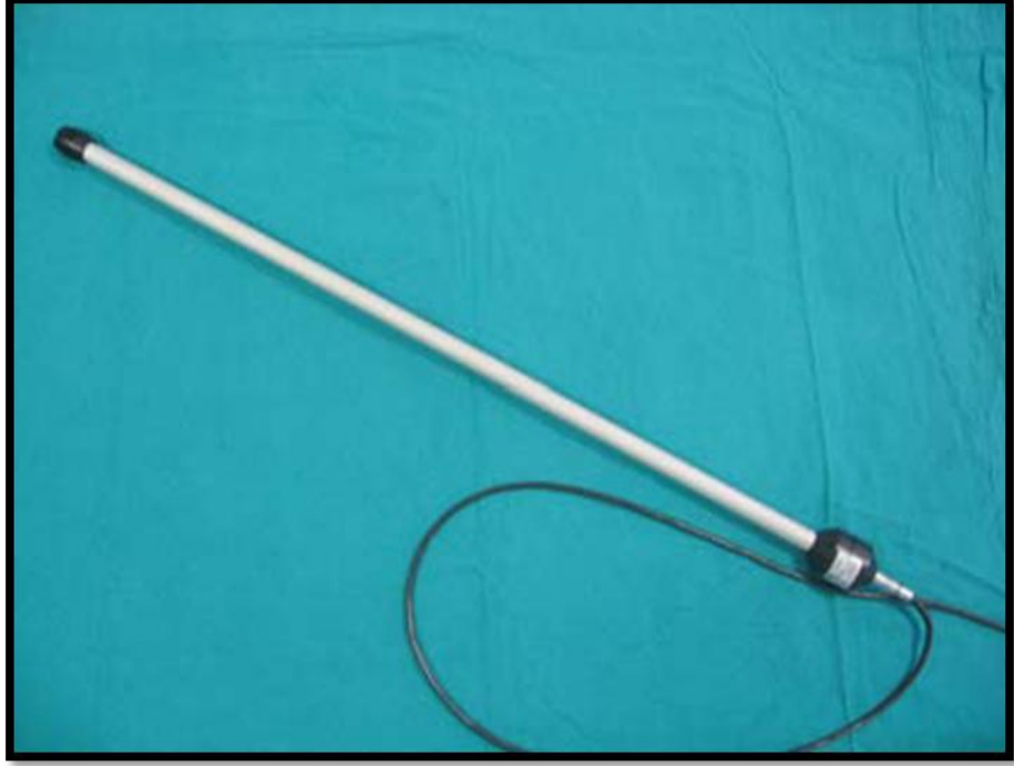
Şekil-3: Akustik rinometride ses sinyallerini yönlendiren tüp.
