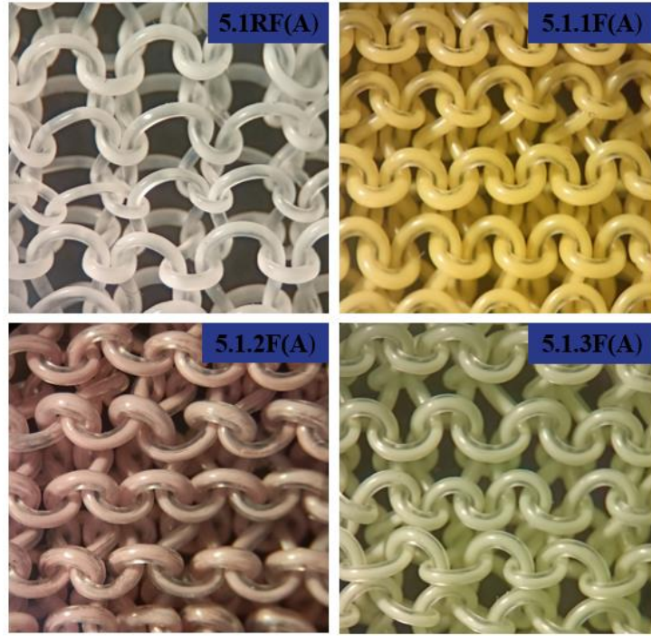
Şekil 4.81. 5/1 dış/iç ekstrüder besleme oranında üretilen bikomponent ipliklerden üretilen yüzeylerin optik mikroskop görüntüleri (Büyütme oranı: 10x)
