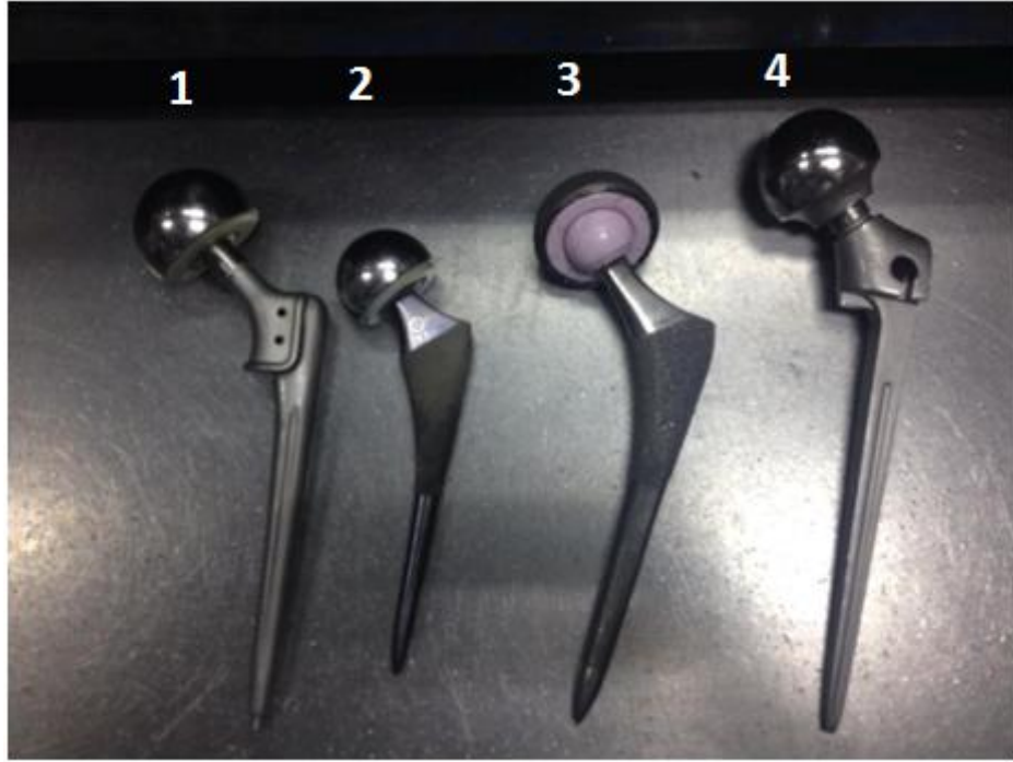
Şekil 3-3: Çalışmada kullanılan protezler [1) Co-Cr-Mo (50mm), 2) Co-Cr-Mo (42mm), 3) Titanyum alaşım (50mm), 4) Paslanmaz çelik (46mm)]
