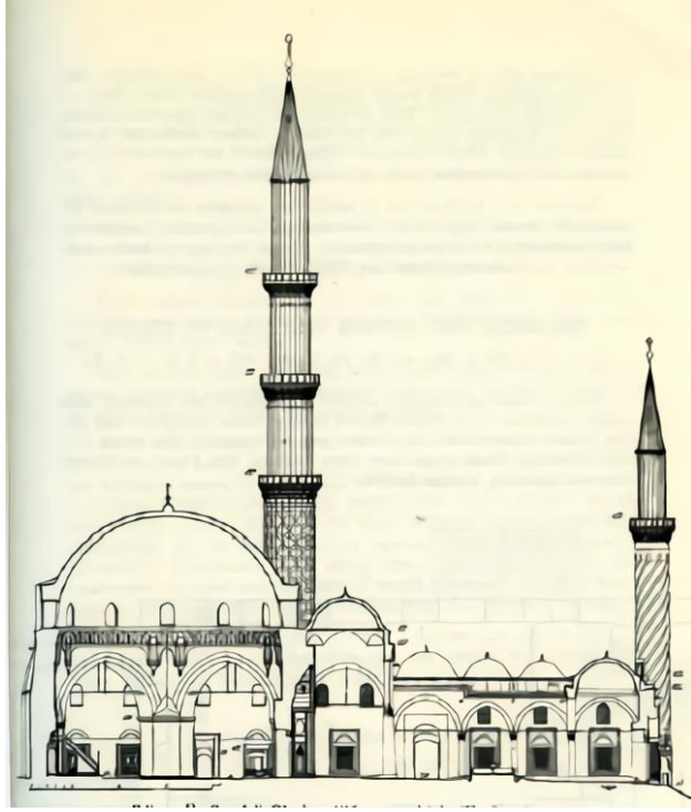
Şekil 78. Edirne Üç Şerefeli Camii, Kesit (Ayverdi, 1976)
