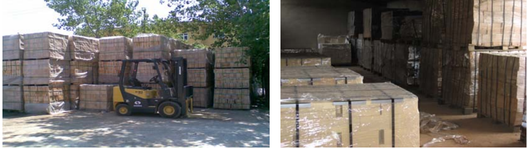
Şekil: 4.12; Kaplama tuğlasının ambalajlanması ve hava koşullarından muhafaza edilmesi. “Kartal Ateş Tuğla Fabrikası, Pendik, İstanbul, (Eyvazoğlu, L. 2008).
