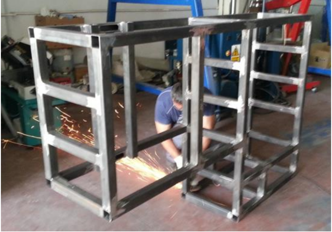
Şekil 3.16. Kasnak Burulma Deney Cihazı Profil Yapısı İmalatı-1
