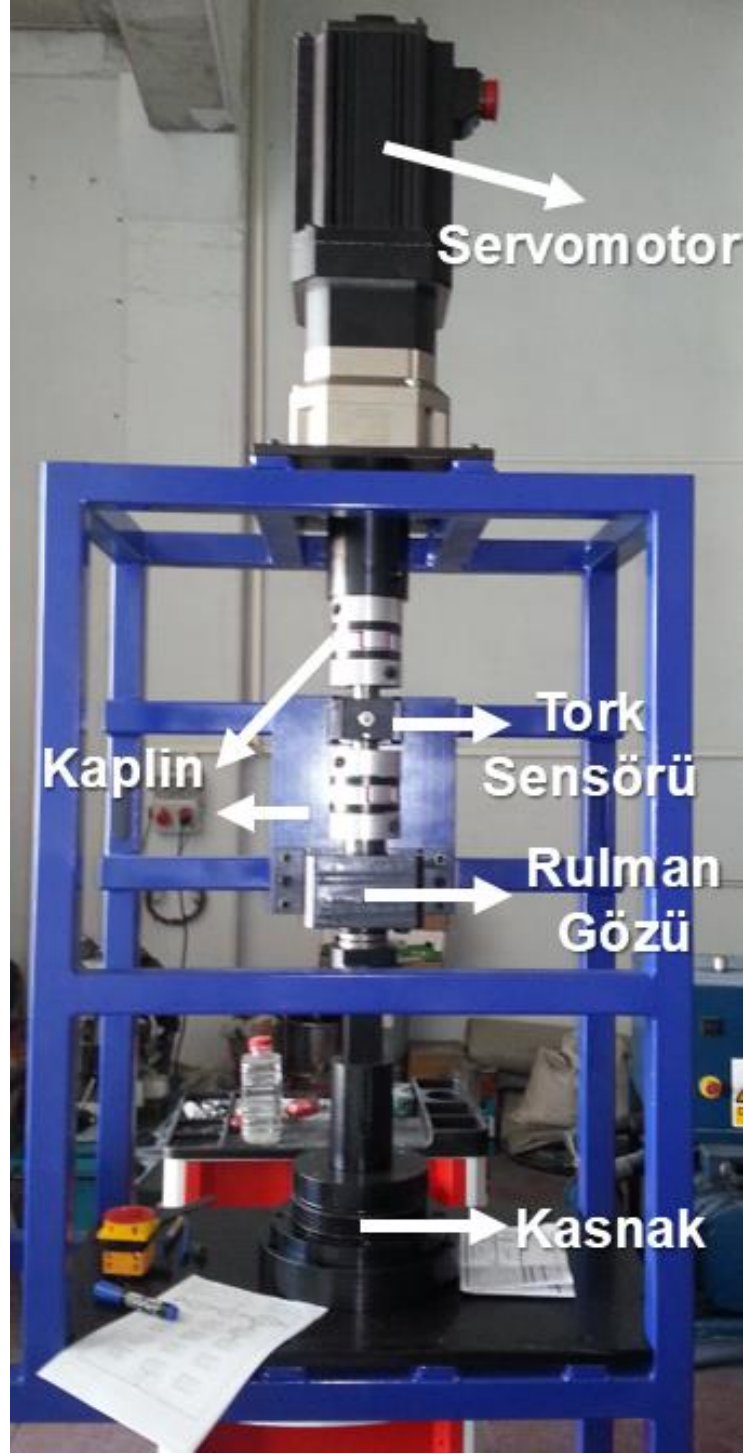
Şekil 3.19. Kasnak Burulma Deney Cihazı Genel Montaj Yapısı
