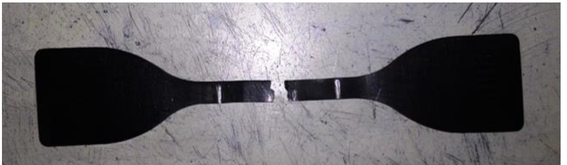
Şekil 3.3. Çekme Deneyi Sonrası Kopan Numune Örneği
