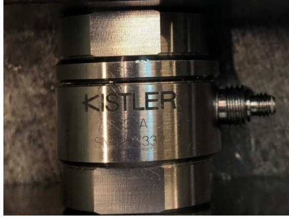
Şekil 3.5. Yapılan deneylerde kullanılan kuvvet ölçüm sensörü
