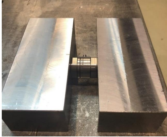
Şekil 3.7. Kuvvet sensörünün iş parçasına bağlanma şekli
