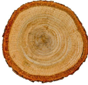
Şekil 3.8. Sert ağaçlara örnek olarak meşe kesiti (Anonim ğ, 2021)
