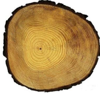
Şekil 3.9. Yumuşak ağaçlara örnek olarak çam kesiti (Anonim h,2021)
