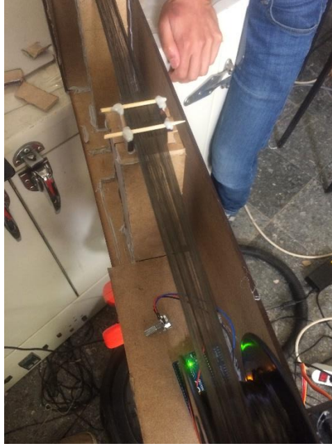
Şekil 3.45. 25 mm ayrılmış karbon fiberin sarımı
