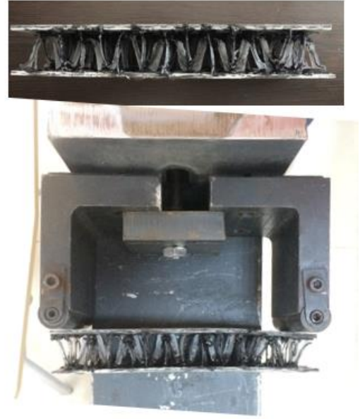
Şekil 4.7. Darbe testi için kullanılan test düzeneği ve numune yerleşimi
