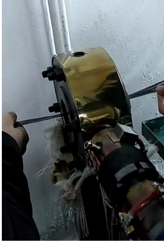
Şekil 3.47. Fiberin polipropilen ile kaplanması
