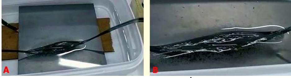
Şekil 3.59. a) Elektrokimyasal oksidasyon işlemi b) İşlem sırasında fiber- elektrolit çözelti etkileşimi.
