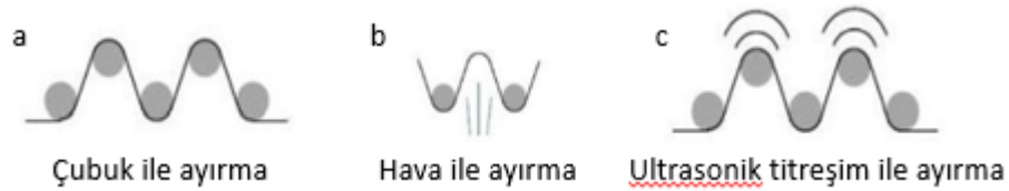
Şekil 2.48. Fiber ayırma yöntemleri (a) çubuk ile ayırma, (b) hava ile ayırma, (c) ultrasonik titreşim ile ayırma (Anonim 2020)
