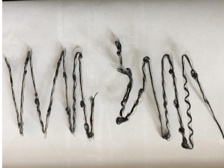
Şekil 3.33. Nozul ve tabla arası mesafenin ideal olmaması durumu
