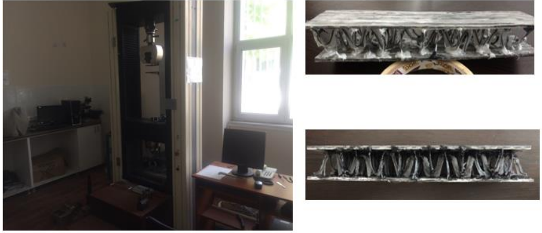
Şekil 4.5. Üç nokta eğilme quasi-statik için kullanılan test cihazı ve numune örnekleri
