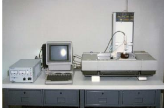
Şekil 2.2. SLA-1 baskı makinesi (Bedir ve ark., 2018)
