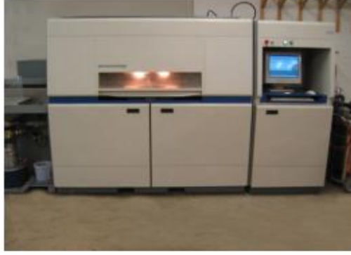
Şekil 2.3. DTM Sinterstation 2000 baskı makinesi (Bedir ve ark., 2018)
