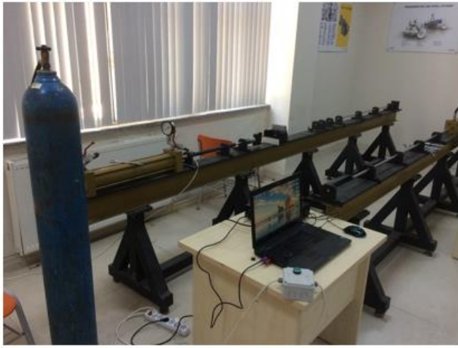
Şekil 4.7. Darbe testi için kullanılan test düzeneği ve numune yerleşimi
