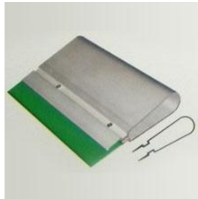
Resim 64. İpek Baskıresim kalıbı (Gazze) ve sıyırıcı (Rakle).
