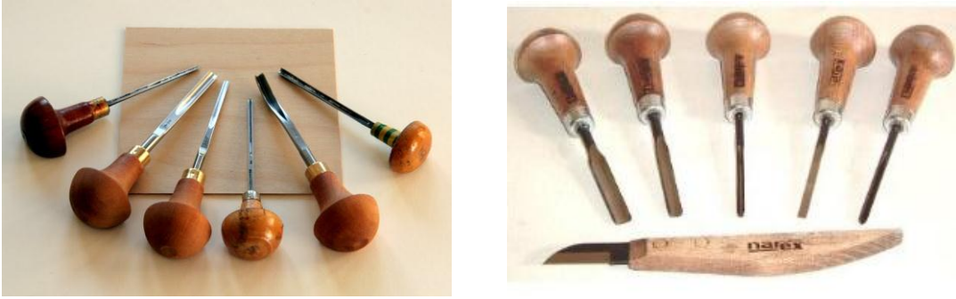
Resim 30. Çeşitli uçlardaki ağaç baskıresim kalıbı oyma bıçakları.
