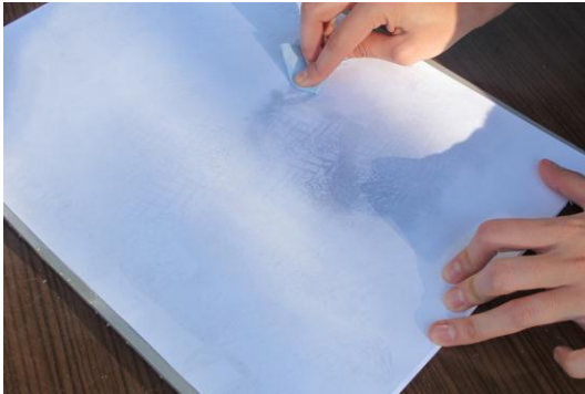
Resim 32. Eskizin kalıp üzerine tiner ve karbon kağıdıyla aktarımı.
