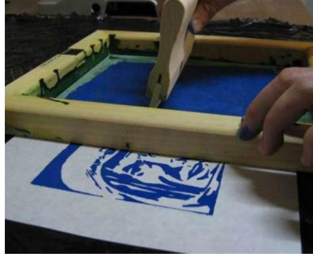
Resim 63. İpek baskıresimin basım aşaması.
