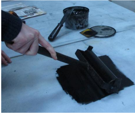
Resim 34. Matbaa boyasının hazırlanması ve kalıbın tahta kaşıkla basım aşaması.
