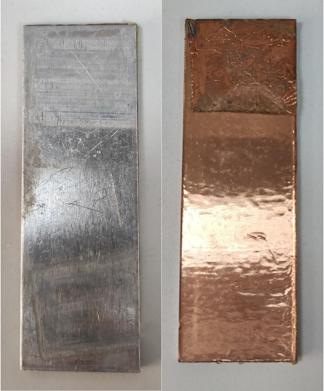
Şekil 3.4. TPV diyot çipinin alüminyum (solda) ve bakır (sağda) yüzeylerinden görünümü
