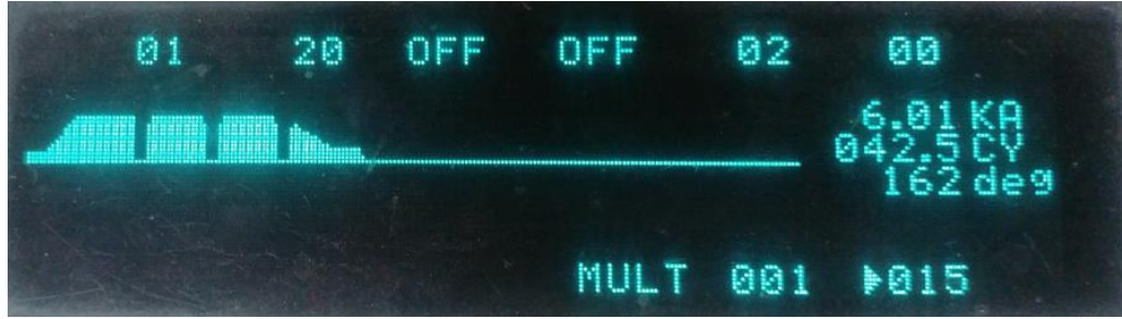
Şekil 4.21. Kaynak parametre denemelerinde ölçülen akım
