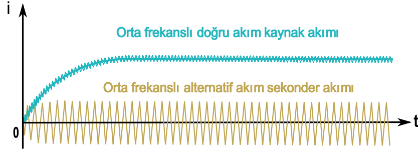
Şekil 2.27. Orta frekanslı alternatif ve orta frekanslı doğru akım karşılaştırması
