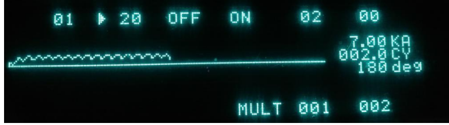
Şekil 4.12. Dengensha WS-80 cihazında ölçülen kaynak akımı
