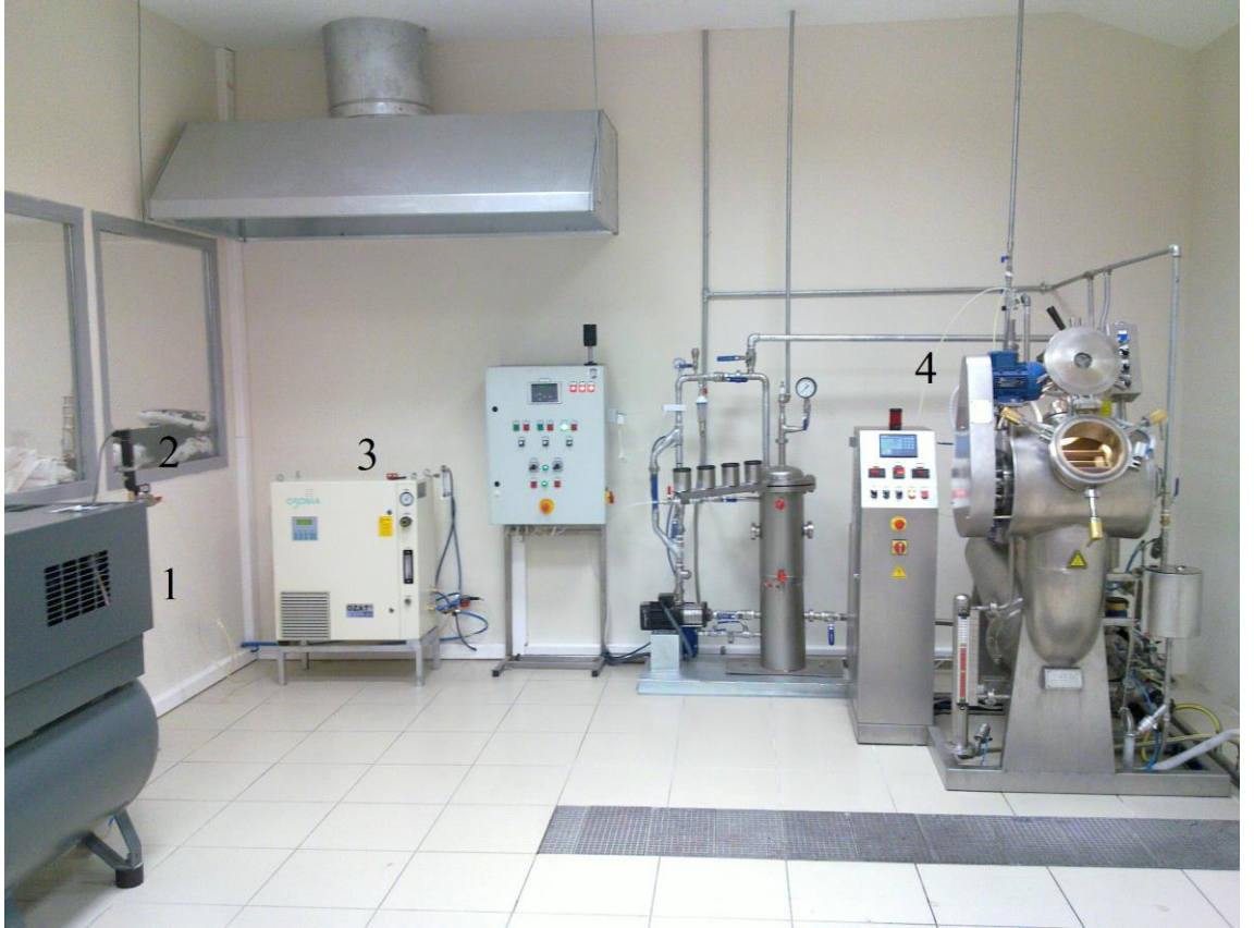
Şekil 3.1. Prototip sistem (1. Kompresör, 2. Desikant kurutucu, 3. Ozon jeneratörü, 4. 1-3 kg'lık Jet Boyama Makinesi)
