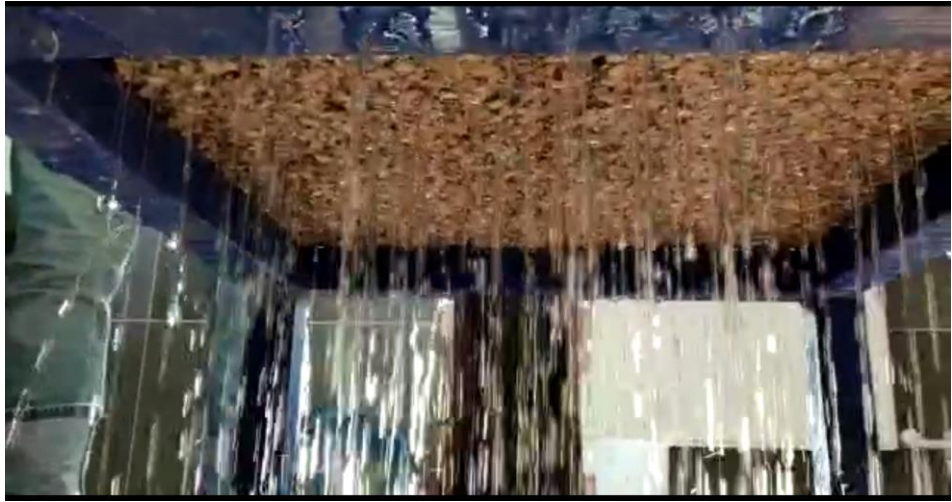
Şekil 3.4. İnfiltrasyon testi sırasında beton alt yüzeyi
