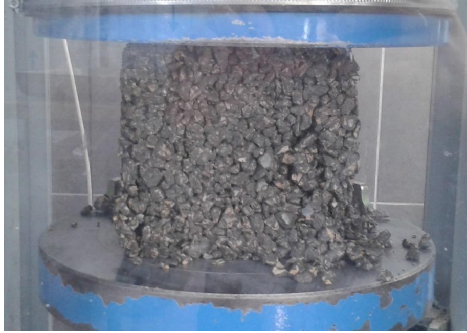
Şekil 3.2. Basınç dayanımı testi
