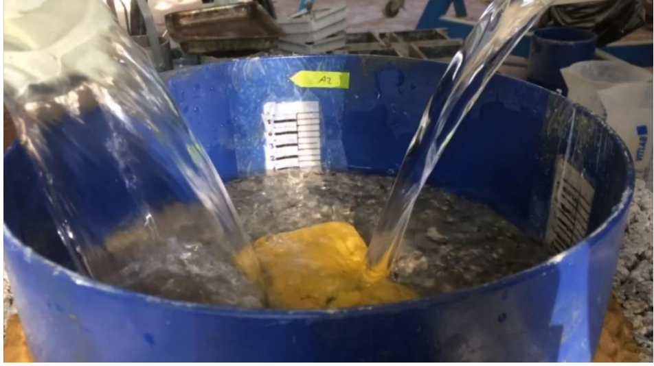
Şekil 3.6. İnfiltrasyon testi sırasında halka içi
