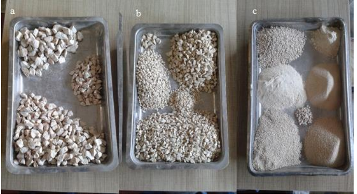
Şekil 3.1. Eleme sonrası agrega örnekleri a) 15-25 mm, b) 5-15 mm ve c) 0-3 mm
