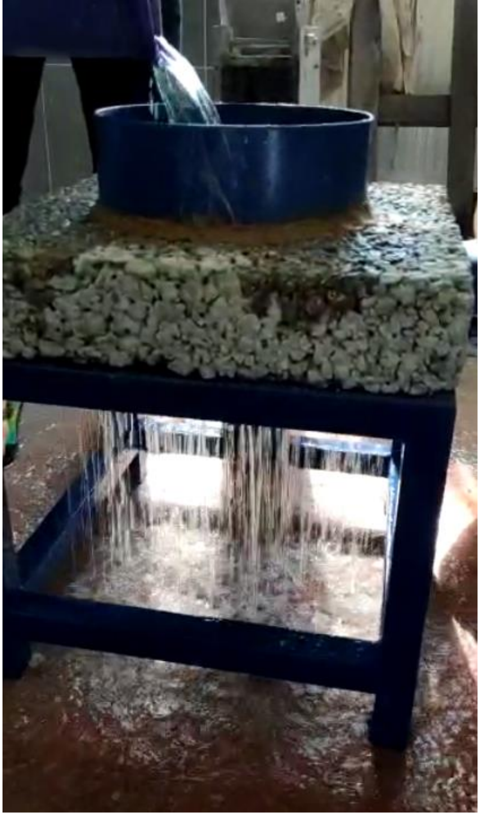
Şekil 3.5. İnfiltrasyon test düzeneđi
