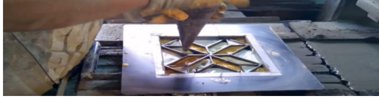
Şekil 2.14. Karosiman renkli katmanın üretim aşaması (Anonim 2021k)
