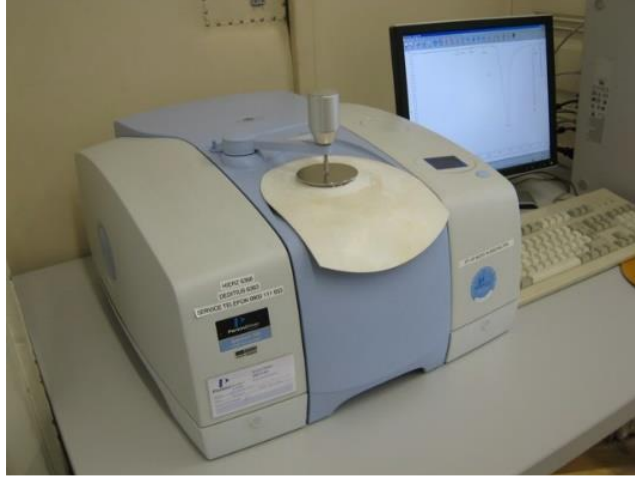
Şekil 3.4. Perkin Elmer Spectrum 100 FTIR spektrometresi
