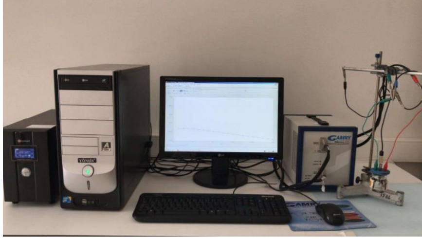
Şekil 3.12. Gamry Reference 3000 Potentiostat/Galvanostat elektrodepozisyon sistemi
