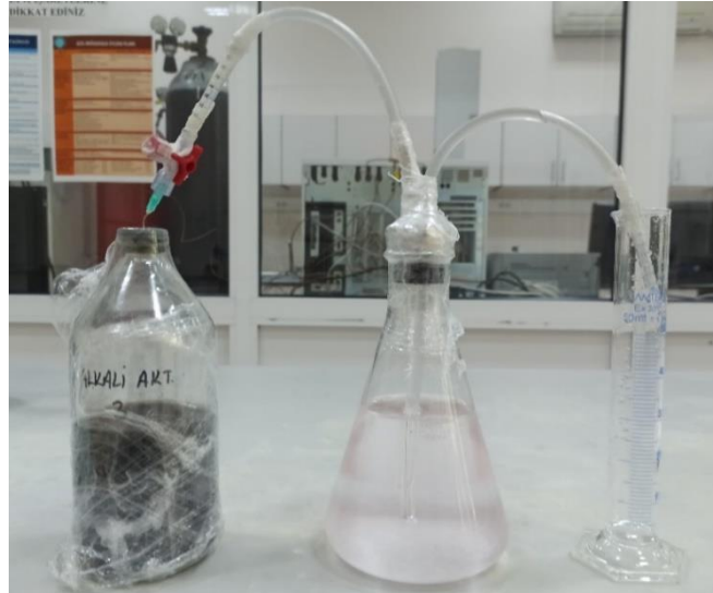
Şekil 3.2. Biyogaz ölçüm düzeneği
