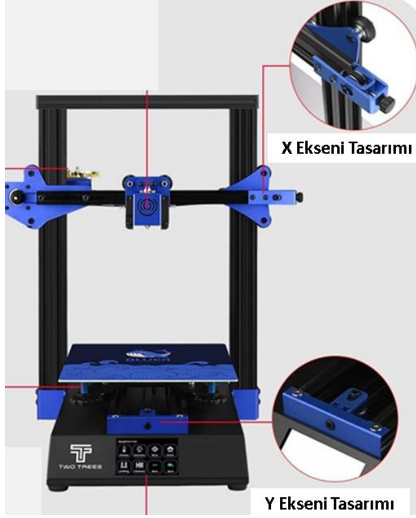
Şekil 3.3 Standart durumdaki twotrees bluer FDM tipi yazıcının X ve Y eksen tasarımları (Anonim 2021j' den değiştirerek alınmıştır.)
