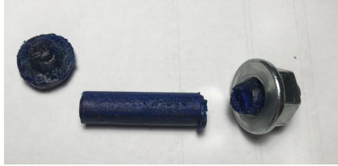
Şekil 4.9 835N yük altında kırılan eksen pimi
