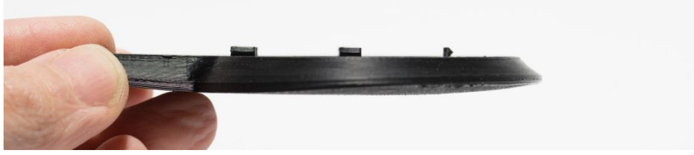
Şekil 2.14 ABS materyali ile basılmış bir parçada gerçekleşen çarpılması örneği(Anonim 2021e’ den alınmıştır.)
