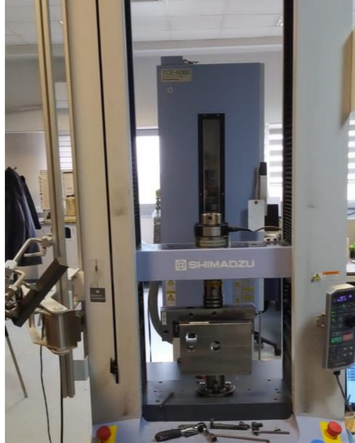
Şekil 3.20 Testlerde kullanılan 'Shimadzu Autograph AGS-X 50 kN' çekme cihazı.
