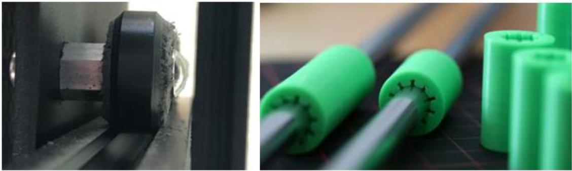
Şekil 3.4 Deforme olmuş bir tekerlek ve yataklama elemanı olarak plastik burç kullanılan mil(Anonim 2021m ve Anonim 2021n' den alınmıştır.)
