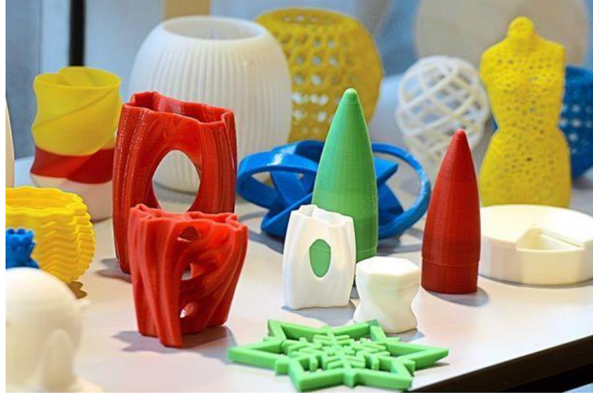
Şekil 2.11 Eriyik yığıma modelleme tipi eklemeli imalat yöntemi ile üretilmiş örnek parçalar(Anonim 2021f' den alınmıştır.)
