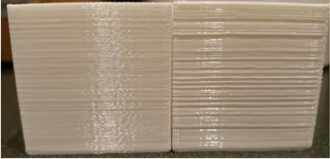
Şekil 3.2 Z eksen düzensizliğinden kaynaklanan parça yüzey pürüzlülüđü örneđi(Anonim 2021k’ den alınmıştır.)
