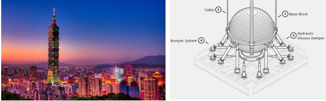
Şekil 2.1. Taipei 101 yapısında kullanılan 730 tonluk ayarlı kütle sönümleyiciler (McFadden, 2020)
