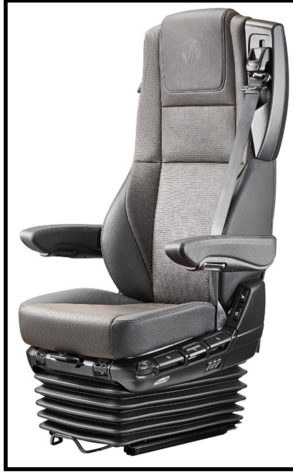
Şekil 3.1. Emniyet kemeri yükseklik ayarı ve omuz ayarı özelliklerine sahip bir koltuk. “Grammer AG”, t.y.
