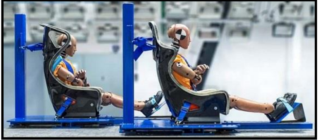
Şekil 3.4. Çarpışma testi örneği
