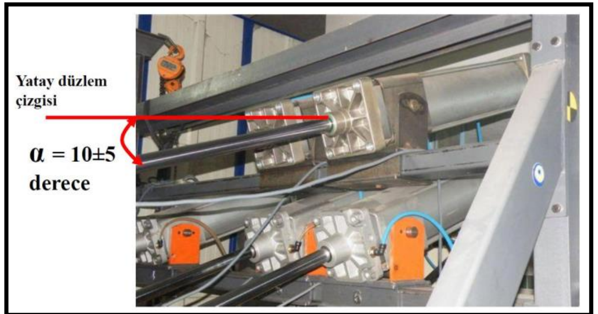
Şekil 3.3. Kuvvet uygulayan pistonların açısı
