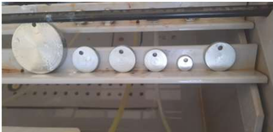
Şekil 4.19. Numunelerin tuz testi yerleşimi
