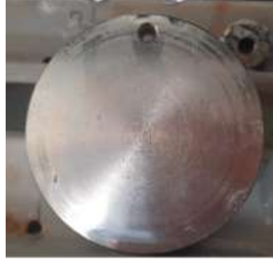
Şekil 4.20. 6 nolu numunede beyaz pas başlangıcı görünümü
