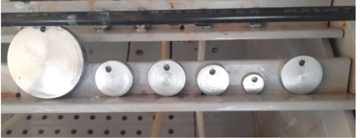
Şekil 4.21. 192 saat sonunda numunelerin tuz testi görünümü
