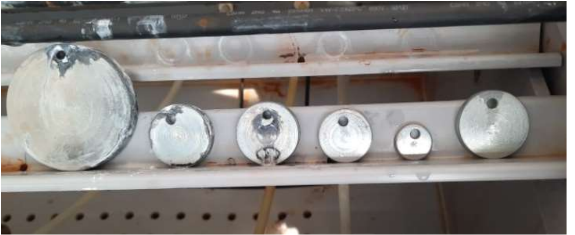
Şekil 4.26. 384 saat sonunda numunelerin tuz testi görünümü
