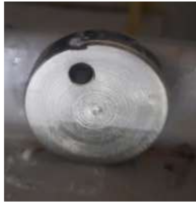
Şekil 4.24. 5 nolu numunede beyaz pas başlangıcı görünümü
