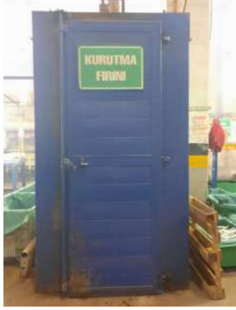
Şekil 4.5. Kaplanan malzemelerin kurutulduğu fırın
