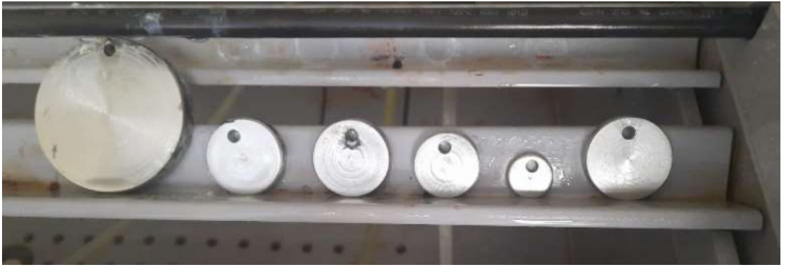
Şekil 4.23. 240 saat sonunda numunelerin tuz testi görünümü
