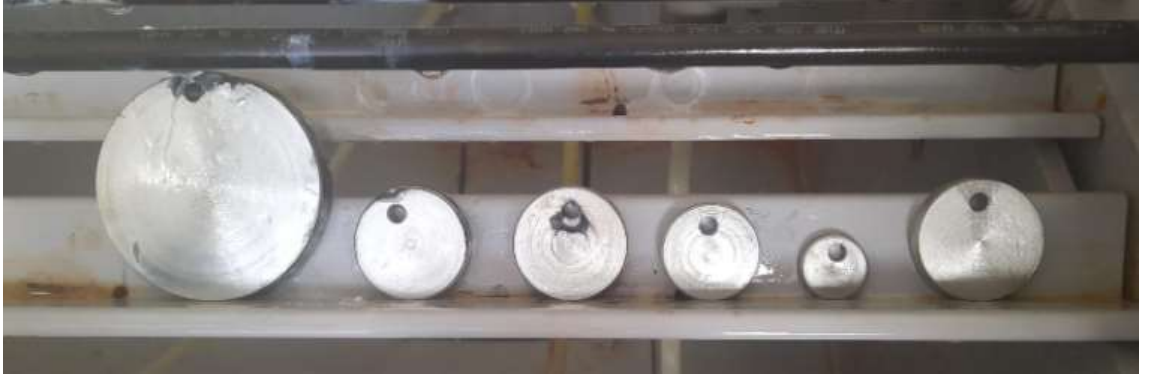
Şekil 4.25. 360 saat sonunda numunelerin tuz testi görünümü
