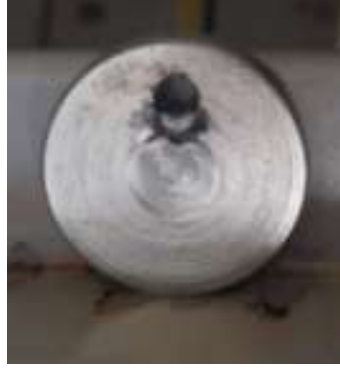
Şekil 4.22. 4 nolu numunede beyaz pas başlangıcı görünümü
