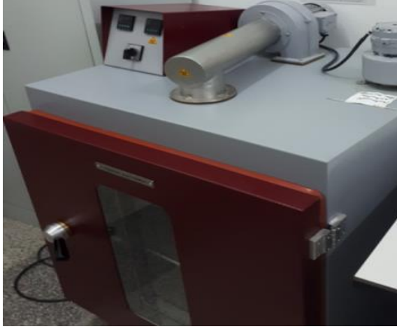
Şekil 3.2. Araştırmada kullanılan konvansiyonel kurutma fırını (Yücebaş marka, 220 V, 50-60 Hz, 200 W, Y35, İzmir)
