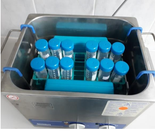
Şekil 3.6. Ultrasonik su banyosunda (Bandelin Sonorex R K512 H) özütlenme aşaması
