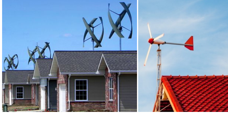
Şekil 2.27. Dikey ve yatay eksenli rüzgâr türbini sistem örnekleri (Anonim 2021r)
