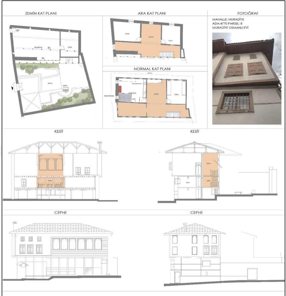
Şekil 3.14. Bursa Muradiye Osmanlı Evi plan, kesit, cephe çizimleri (B.K.V.K.B.K. esas alınarak yeniden düzenlenmiştir)
