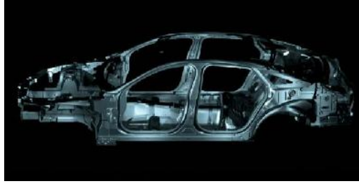
Şekil 3.20. Jaguar - XJ , tamamında alüminyum kullanılan ilk monokok şasi
