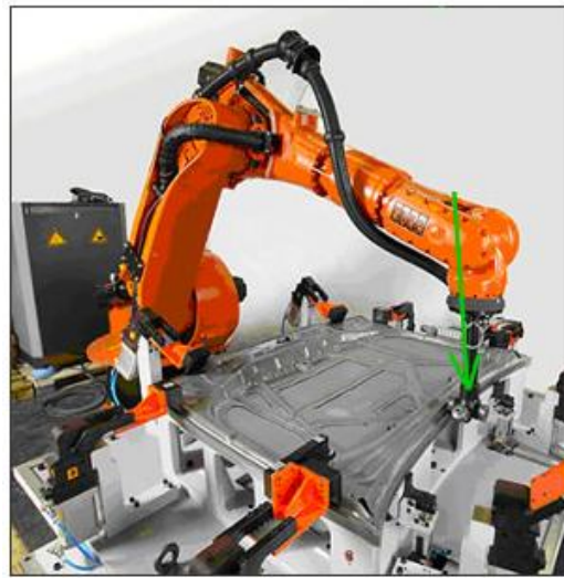
Şekil 3.81. Bir robotlu roller kenar bükerek kenetleme örneği
