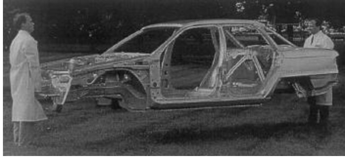
řekil 3.13. Alcan – Ford yoğun alüminyum kullanılmıř olan sac monokok mimarisi
