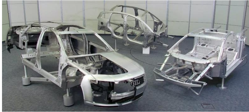
Şekil 3.19 Audi uzay çatı tekniği kullanılan gövde örnekleri
