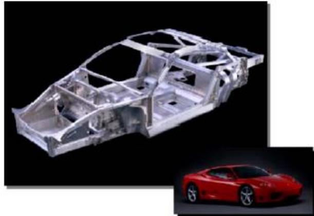
Şekil 3.15. Ferrari F360 aracının alüminyum ekstrüzyonlu uzay çatılı gövde yapısı
