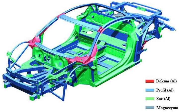
Şekil 3.21 Audi A8 uzay çatı gövdesi
