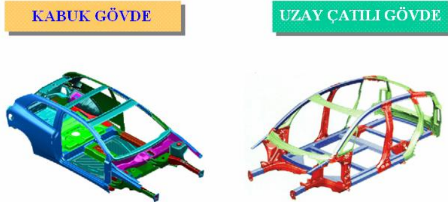
Şekil 3.9. Kabuk ve uzay çatılı gövde uygulamaları
