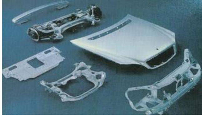
Şekil 3.5. S – sınıfı Mercedes'te kullanılan alüminyum parçalar
