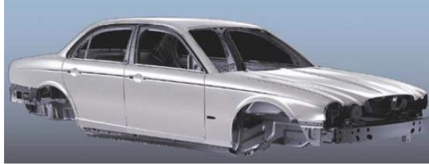
Şekil 3.18. Alüminyumdan yapılmış bir gövde örneği
