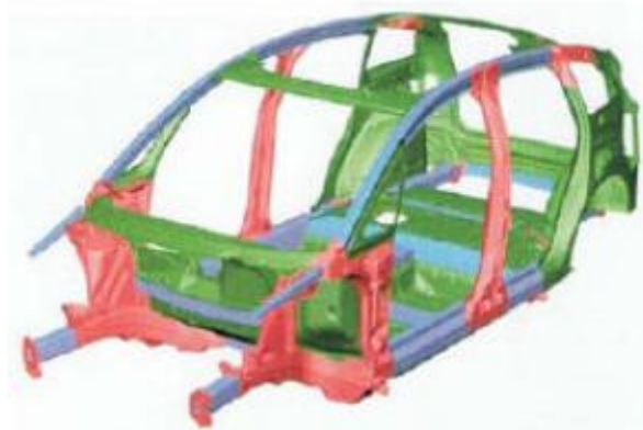
Şekil 3.11. Audi ikinci nesil gövde ve yarı malzeme dağılımı
