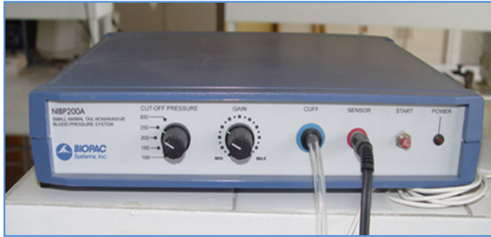
Şekil 21: NIBP 200A non-invaziv kan basıncı ölçüm cihazı.
