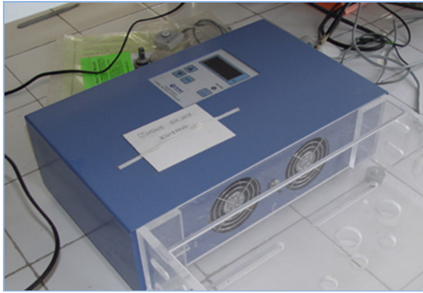
Şekil 23: Deney hayvanlarının ısıtılmasında kullanılan ısıtıcı ünite.
