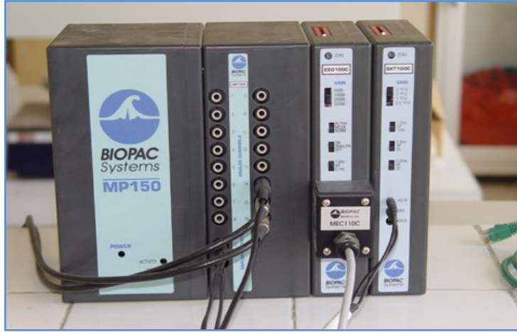
Şekil 20: MP150 veri yakalama sistemi (Data acquisition system).
