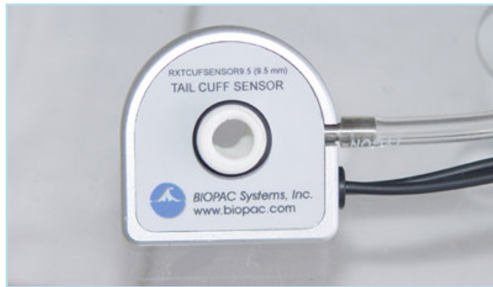
Şekil 24: Kan basıncının ölçülebilmesi için deney hayvanlarının kuyruklarına yerleştirilen IR algılayıcı (Rxtsensor-8).
