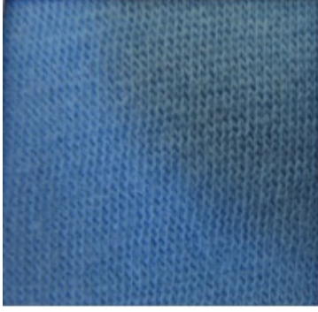
Şekil 5. E34 incelikli yuvarlak örme makinesinde orta ayarda örülmüş süprem kumaşların a) aşınma mukavemeti testi öncesi b) ) aşınma mukavemeti testi sonrası fotoğrafları
