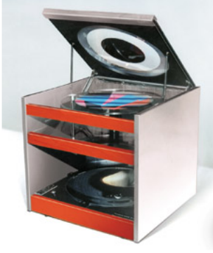
Şekil 2.5. SDL ATLAS-Kumaş dökümlülüğü test cihazı ( www.sdlatlas.com )
