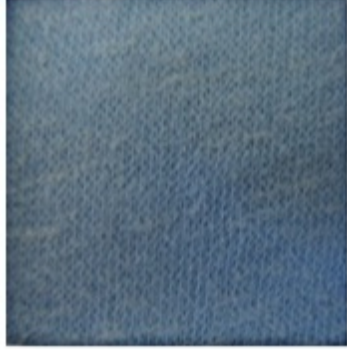
Şekil 1. E34 incelikli yuvarlak örme makinesinde elastansız a)Ne60/1 b)Ne80/1 numaradaki iplikler ile örülmüş elastansız kumaşların aşınma testi sonrası fotoğrafları
