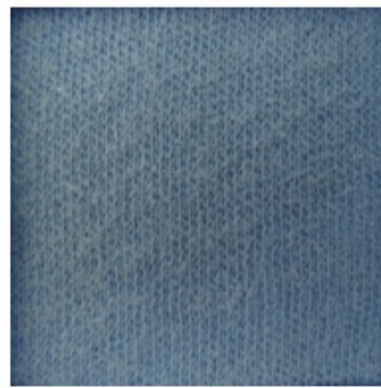
Şekil 6. E34 incelikli yuvarlak örme makinesinde sıkı ayarda örülmüş süprem kumaşların a) aşınma mukavemeti testi öncesi b) ) aşınma mukavemeti testi sonrası fotoğrafları
