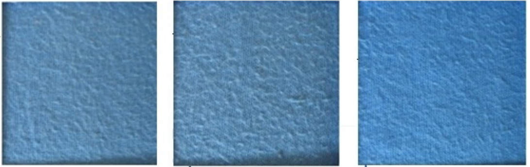
Şekil 2. E34 incelikli yuvarlak örme makinesinde örülmüş süprem kumaşların boncuklanma testinden sonraki görünüşleri a)Açık ayar b)Orta ayar c)Sıkı ayar
