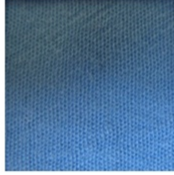
Şekil 1. E34 incelikli yuvarlak örme makinesinde elastansız a)Ne60/1 b)Ne80/1 numaradaki iplikler ile örülmüş elastansız kumaşların aşınma testi sonrası fotoğrafları
