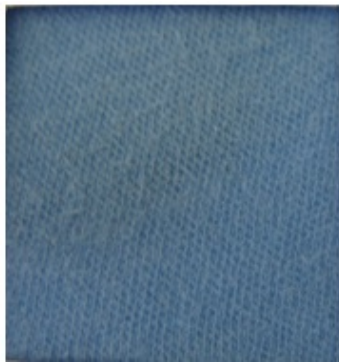
Şekil 3. E34 incelikli yuvarlak örme makinesinde a)Ne80/1 elastansız b)Ne80/1 elastanlı iplikler ile örülmüş kumaşların aşınma testi sonrası fotoğrafları
