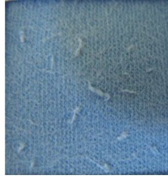
Şekil 2. E34 incelikli yuvarlak örme makinesinde a)Ne60/1 elastansız b)Ne60/1 elastanlı iplikler ile örülmüş kumaşların aşınma testi sonrası fotoğrafları
