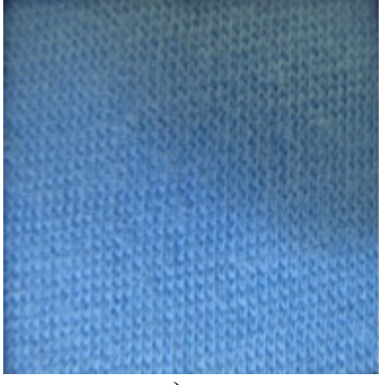
Şekil 4. E34 incelikli yuvarlak örme makinesinde açık ayarda örülmüş süprem kumaşların a) aşınma mukavemeti testi öncesi b) ) aşınma mukavemeti testi sonrası fotoğrafları
