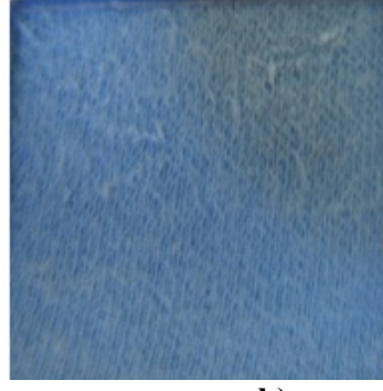
Şekil 4. E34 incelikli yuvarlak örme makinesinde açık ayarda örülmüş süprem kumaşların a) aşınma mukavemeti testi öncesi b) ) aşınma mukavemeti testi sonrası fotoğrafları
