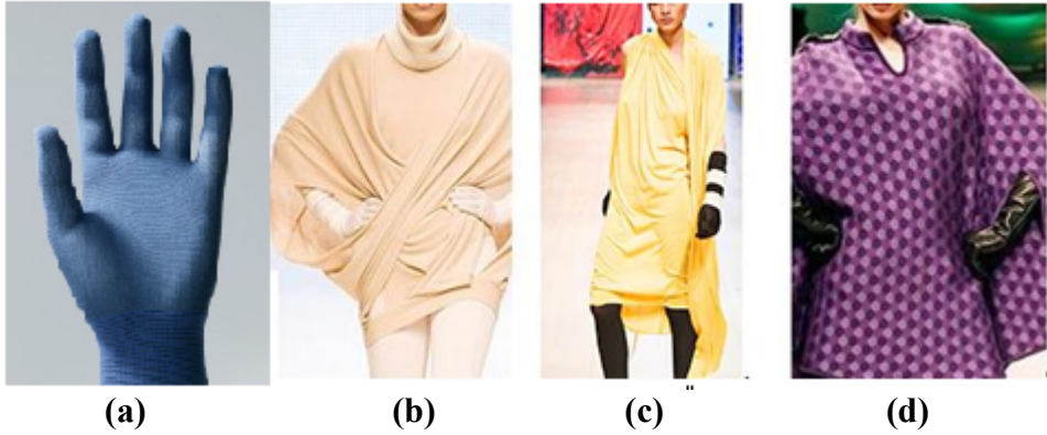
Şekil 1.5. Shima Seiki Marka a)E18 incelikli eldiven makinesinde örülmüş eldiven örneği b) SWG173-X15 tipi E15 incelikli düz örme makinesinde örülmüş kazak c)First 153 S18 tipi E18 incelikli düz örme makinesinde örülmüş elbise d) First 184 L12 tipi E7 incelikli düz örme makinesinde örülmüş panço KAYNAK: http://www.shimaseiki.com , 2010)
