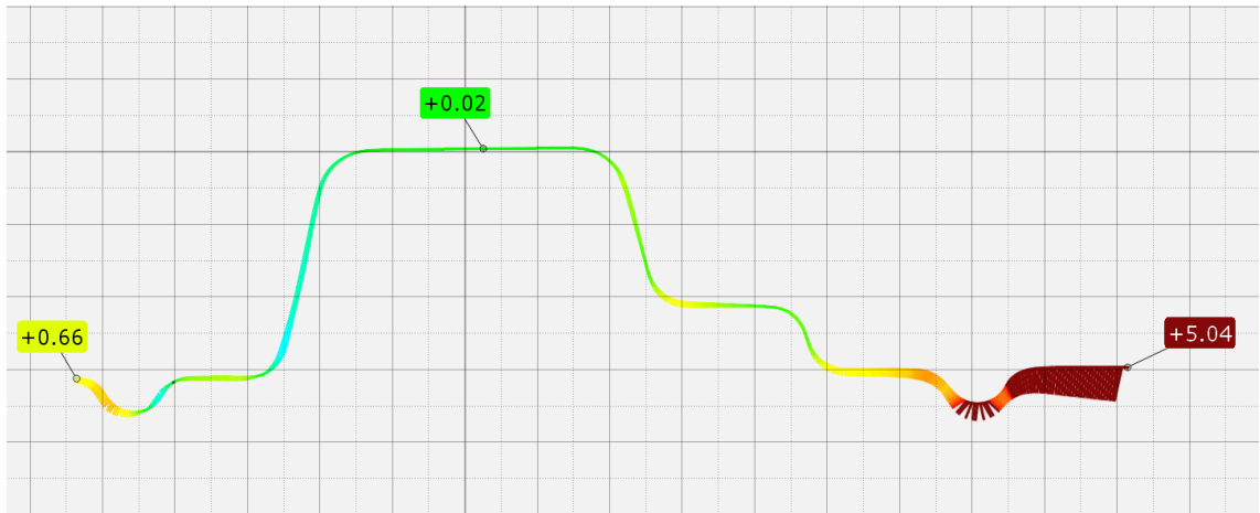
Şekil 4.81. AA5182 Barlat Modeli Simülasyonu Geri Yaylanma Tahminindeki Sapmalar
