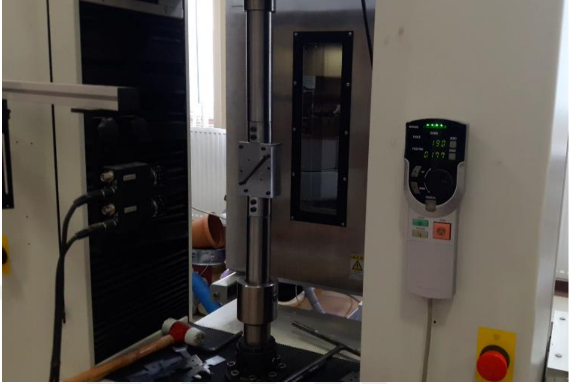
Şekil 3.19. Çevrimli Çekme Basma Test Düzenegi
