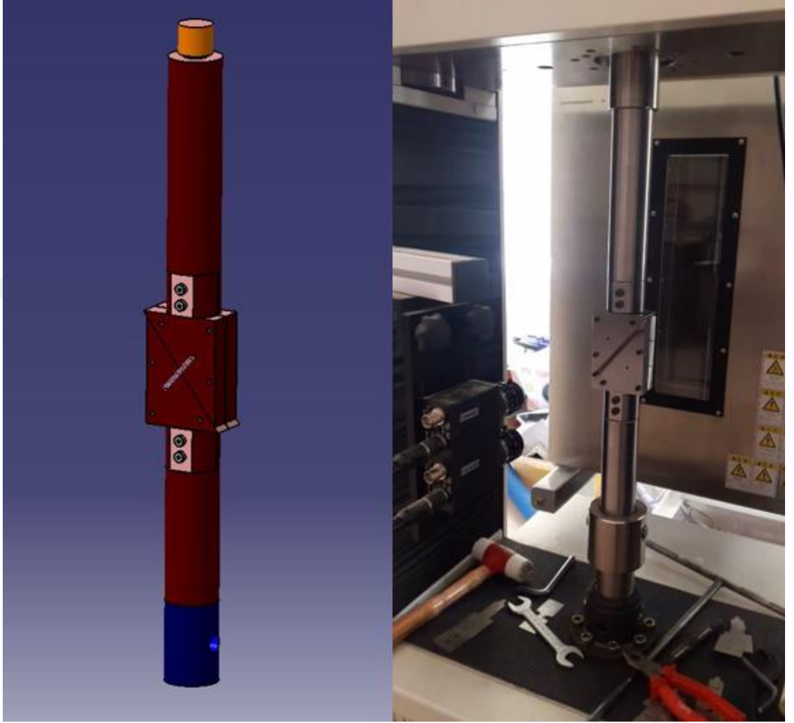
Şekil 3.18. Metal Malzemedan Üretilen Burkulma Önleyici Aparat
