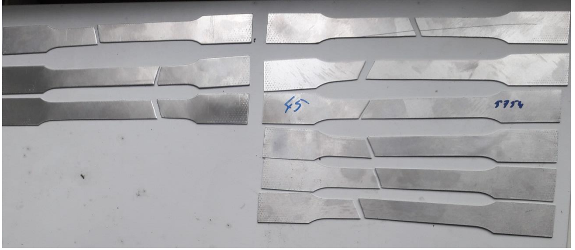
Şekil 4.8. AA5754 Malzemesine Ait Çekilmiş Test Numuneleri
