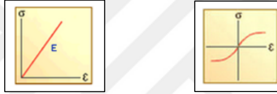
Şekil 2.3. Doğrusal (Linear) ve Doğrusal Olmayan (Non-Linear) Uzama
