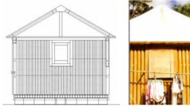
Şekil 2.18. Kağıt geçici birimlere ait kesit ve görünümü (Arslan 2004)
