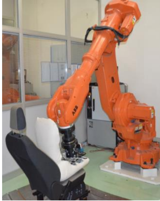
Şekil 3.23. Koltuk giriş-çıkış testi için kullanılan robot
