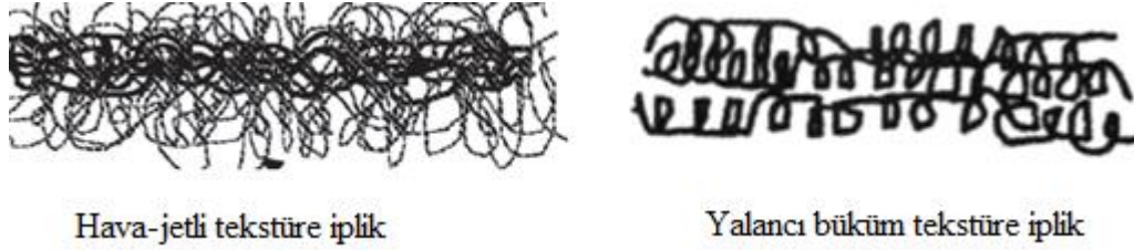
Şekil 2.4. Hava-jetli tekstüre ve yalancı büküm yöntemiyle tekstüre edilmiş iplik yapılarının şematik gösterimi
