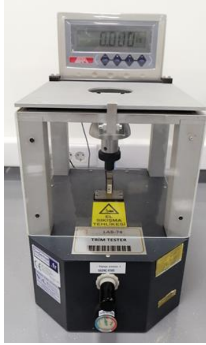
Şekil 3.22. Giydirilebilirlik testinin uygulandığı Sodemat Trimtester marka test cihazı
