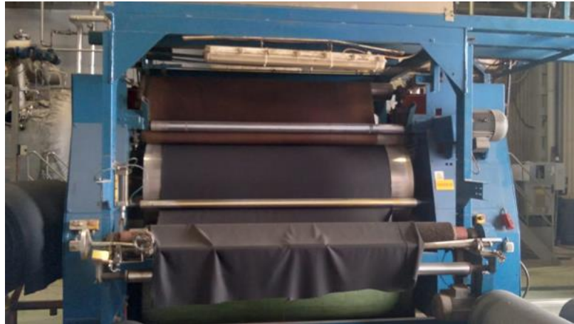
Şekil 3.7. Isıyla kuru laminasyon tekniğinde kullanılan sıcak silindirli kalender makinesi
