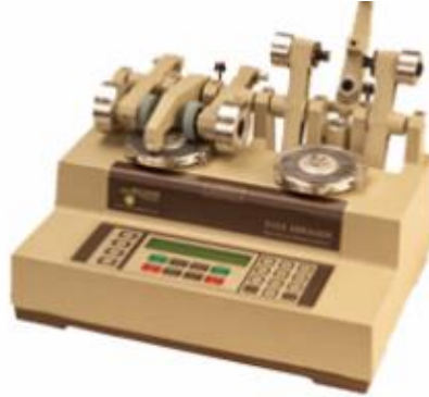
Şekil 3.16. Taber aşınma test cihazı ( https://www.rycobel.com/products/taber-abraser )
