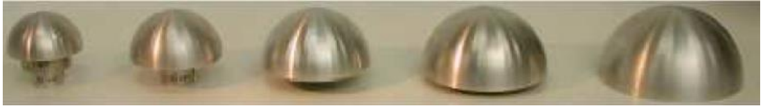
Şekil 3.20. Giydirilebilirlik testinde kullanılan test yarım küreleri
