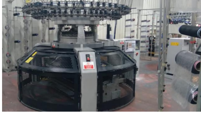
Şekil 3.3. Örme kumaşların üretiminde kullanılan yuvarlak örme makinesi
