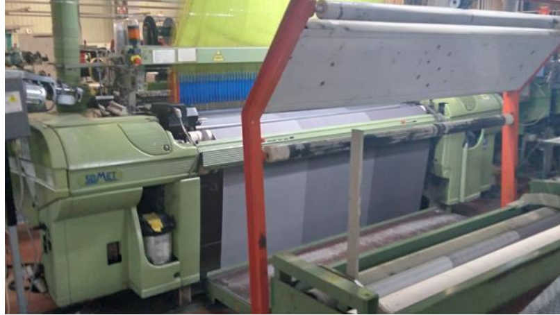
Şekil 3.2. Dokuma kumaşların üretiminde kullanılan dokuma makinesi
