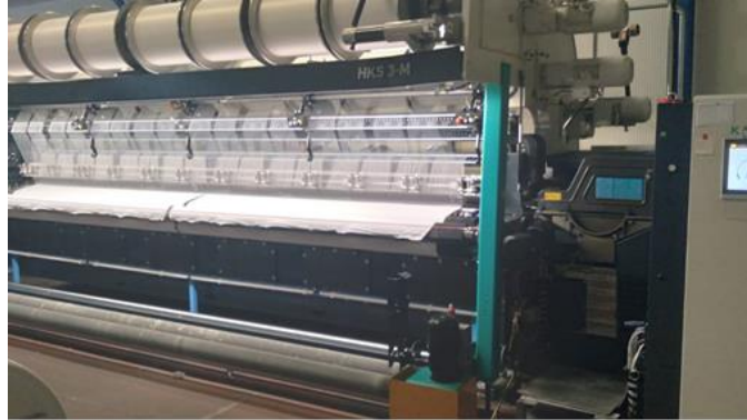
Şekil 3.11. Çözgülu örme baskı bezi kumaşların üretiminde kullanılan çözgülu örme makinesi
