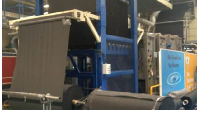
Şekil 3.4. Kumaşların yıkanmasında kullanılan açık en yıkama makinesi
