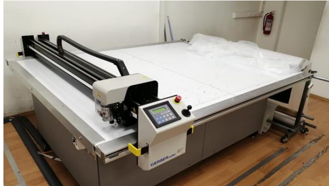
Şekil 3.13. Kesim işleminde kullanılan kesim makinesi
