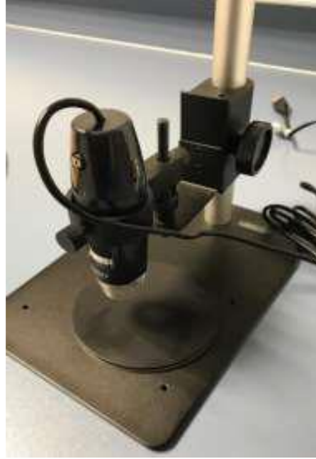
Şekil 3.5. Numunelerin yüzeylerini incelemek için kullanılan mikroskop (INSIZE)
