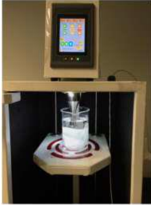
Şekil 3.1. Denemelerde kullanılan ultrasonik homojenizatör ve ses koruma kabini (NANOLINKER NL400)
