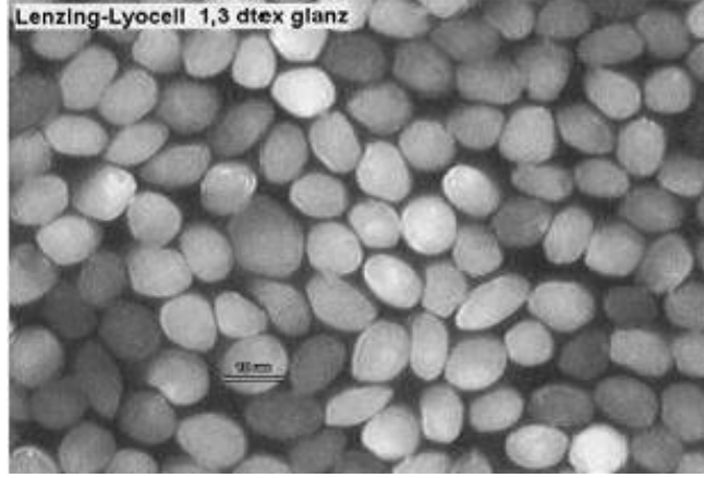
Şekil 2.12. Liyosel liflerinin enine kesit görüntüleri (Dündar 2008).
