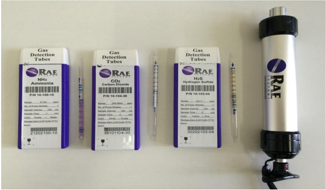
Şekil 3.4. Çalışmada gaz ölçümlerinde kullanılan tüpler ve pompa
