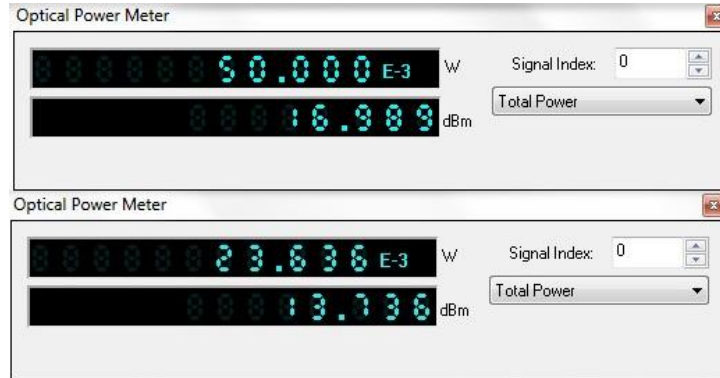
Şekil 4.12. GPON giriş gücü ve OLT birimi verici gücü
