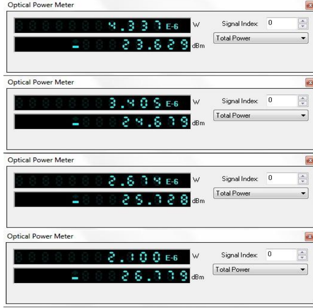
Şekil 4.13. Sırayla 5, 10, 15 ve 20 km ana fiber hat mesafesinde ONU 1 abonesine aktarılan güçler
