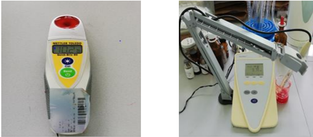
Şekil 3. 25. Suda çözünebilir kuru madde içeriği (%) ve pH ölçümleri.
