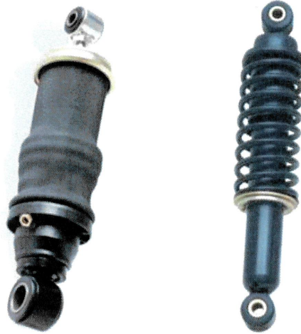
Şekil 2.10. Körüklü ve yaylı (mekanik) kabin amortisörü (Çetin 2019)
