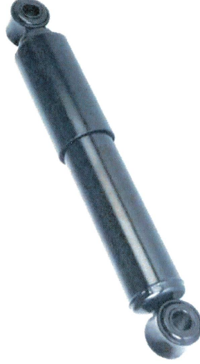
Şekil 2.9. Ağır ticari araç teleskopik tip amortisör
