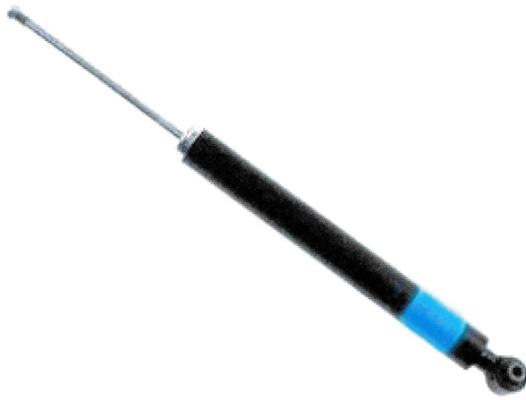
Şekil 2.8. Binek araç teleskopik tip arka amortisör
