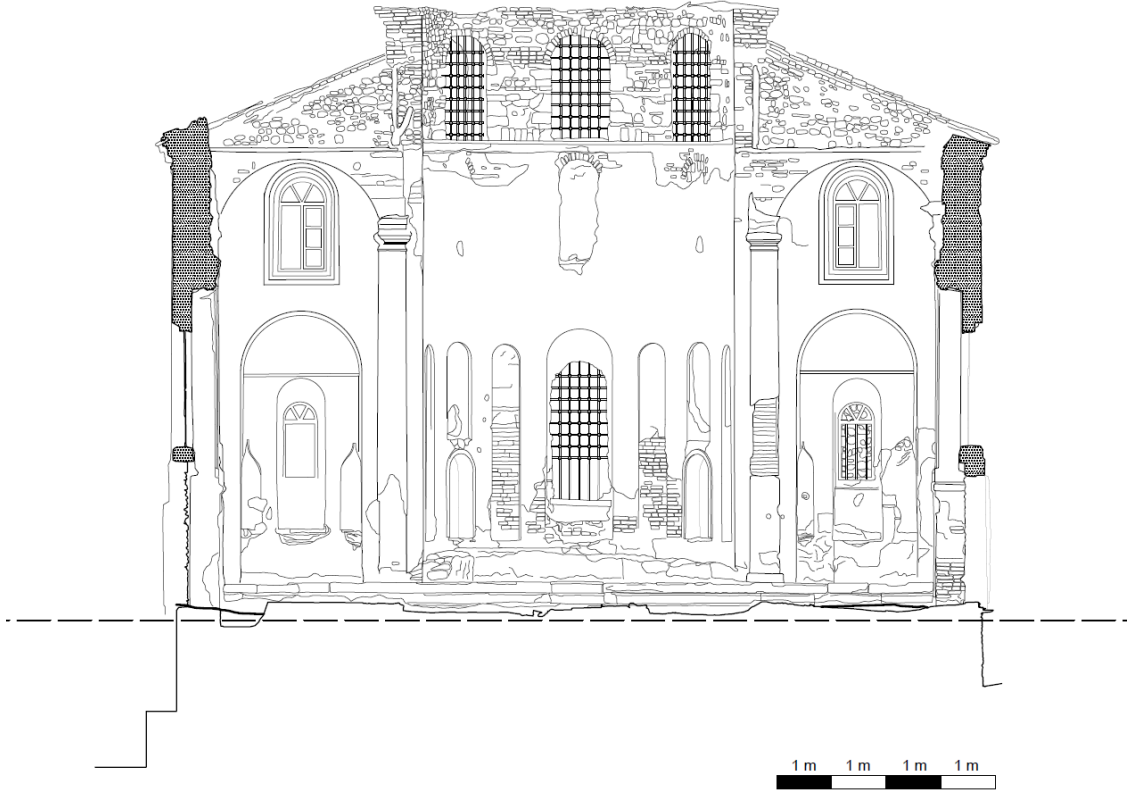
Şekil 38: Deriköy Ayia Paraskevi Kilisesi Kuzey-Güney Kesiti, Rölöve (Çizim: Y. Mim. Rahmi Dede)
