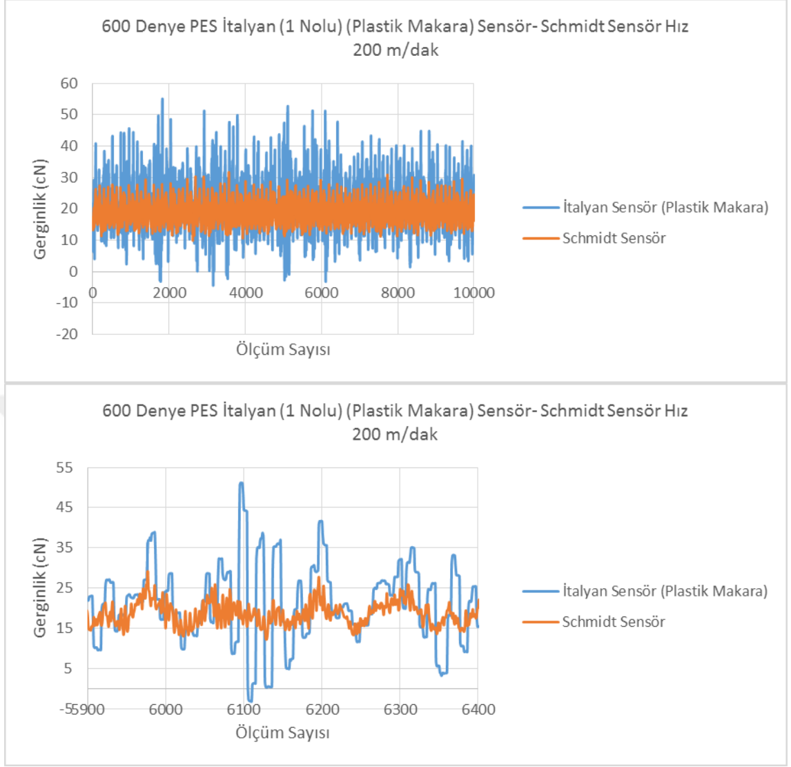
Şekil 4.10. 1 Nolu yük hücresine sahip gerginlik sensörü 200 m/dak hız ile çalışmada gerginlik değişimi sonuçları (plastik makara ile)
