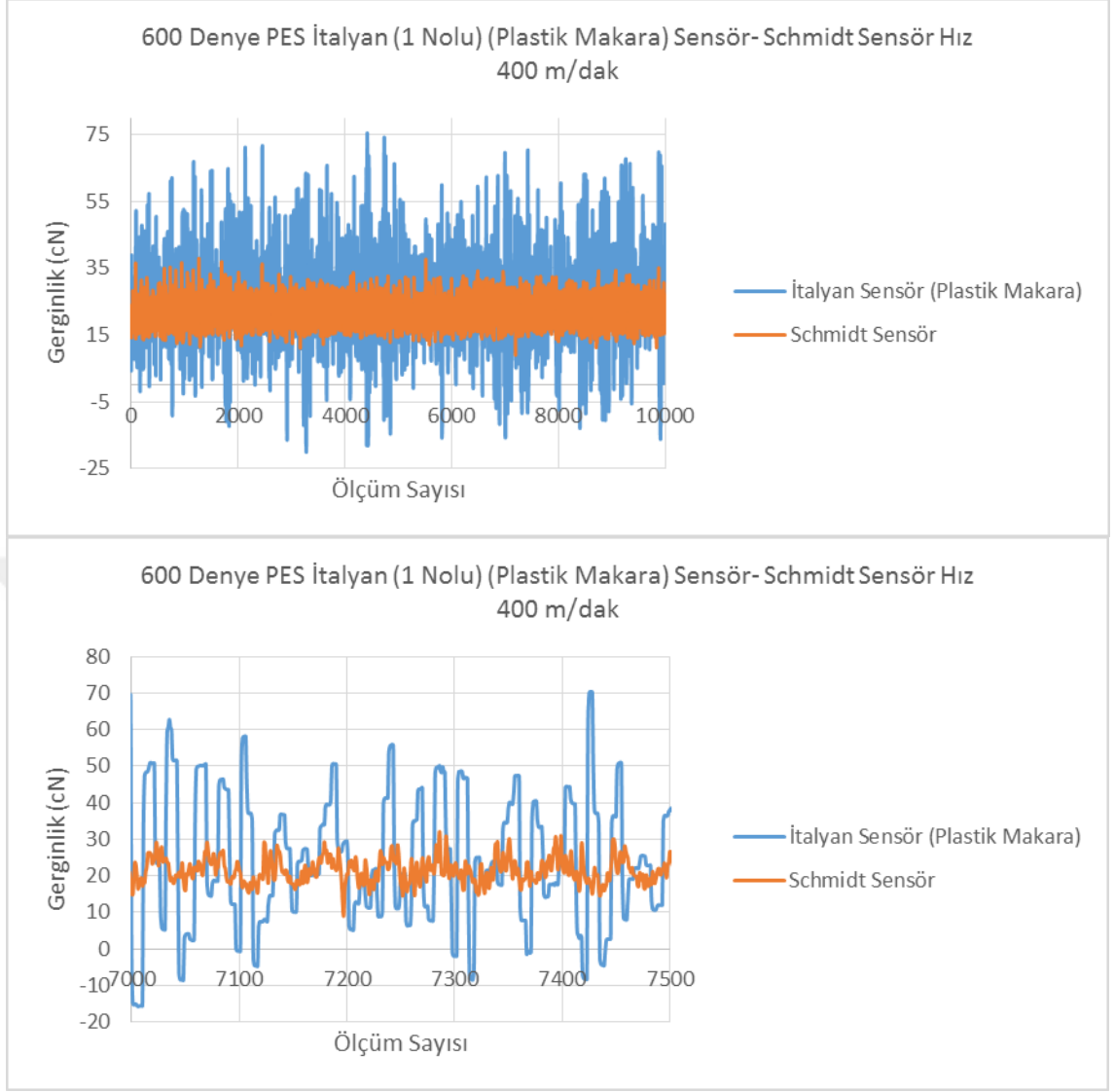
Şekil 4.11. 1 Nolu yük hücresine sahip gerginlik sensörü 400 m/dak hız ile çalışmada gerginlik değişimi sonuçları (plastik makara ile)
