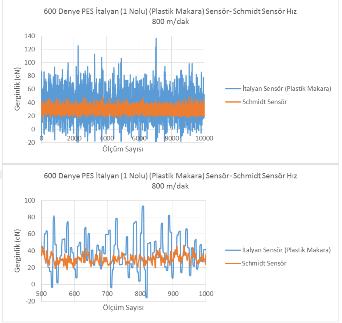
Şekil 4.13. 1 Nolu yük hücresine sahip gerginlik sensörü 800 m/dak hız ile çalışmada gerginlik değişimi sonuçları (plastik makara ile)
