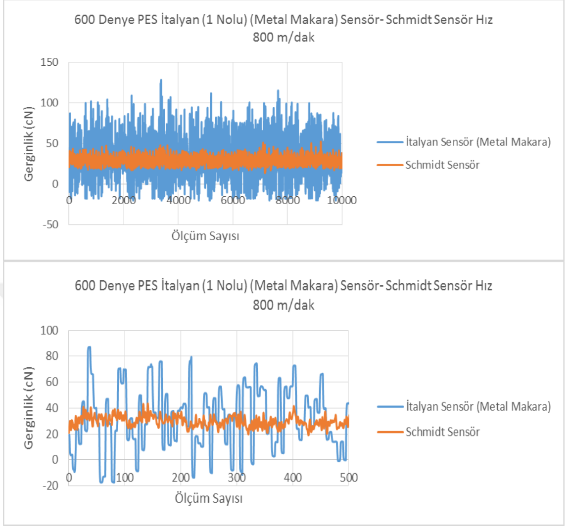
Şekil 4.6. 1 Nolu yük hücresine sahip gerginlik sensörü 800 m/dak hız ile çalışmada gerginlik değişimi sonuçları (metal makara ile)
