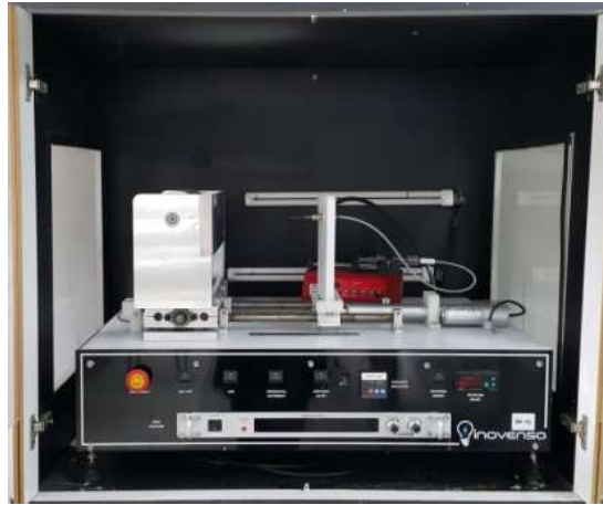
Şekil 3.7. Üretim çalışmalarında kullanılan Elektro Çekim Ünitesi
