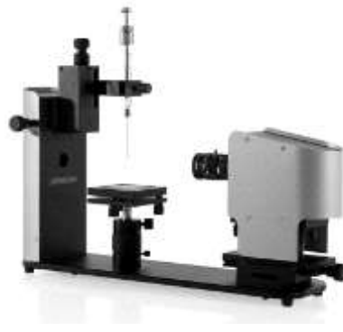
Şekil 3.6. Attension Theta Temas Açısı Ve Yüzey Gerilimi Ölçüm Cihazı
