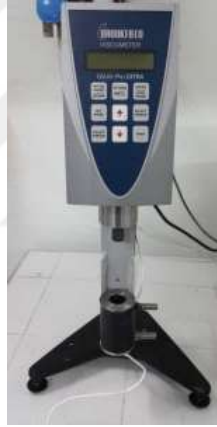
Şekil 3.5. Brookfield RV-DV II Viskozimetre Ölçüm Cihazı
