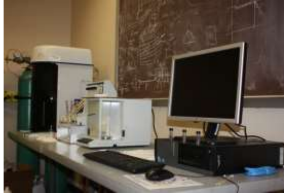
Şekil 3.12. Yüzey Alanı ve Mikro Gözenek Boyutu Analiz Cihazı
