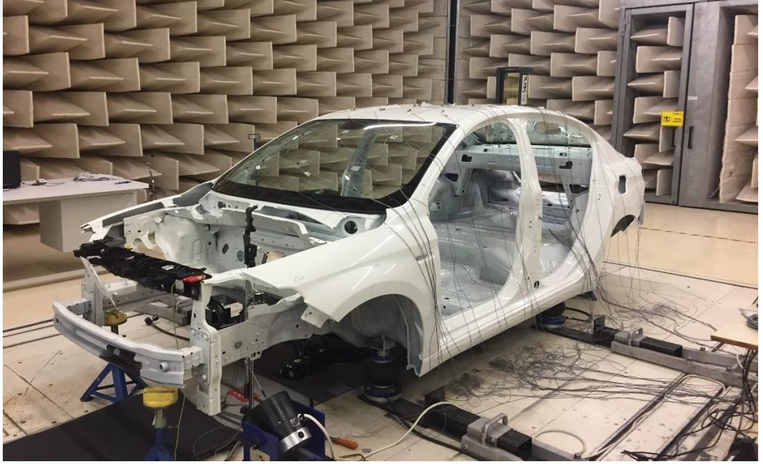
řekil 4.17. Titreřim testi ara hazırlıęı
