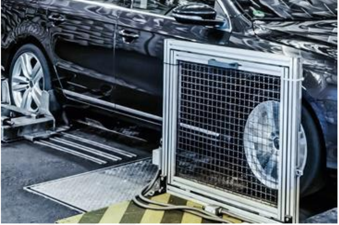
Şekil 3.7. Örnek bir roller test bankosu
