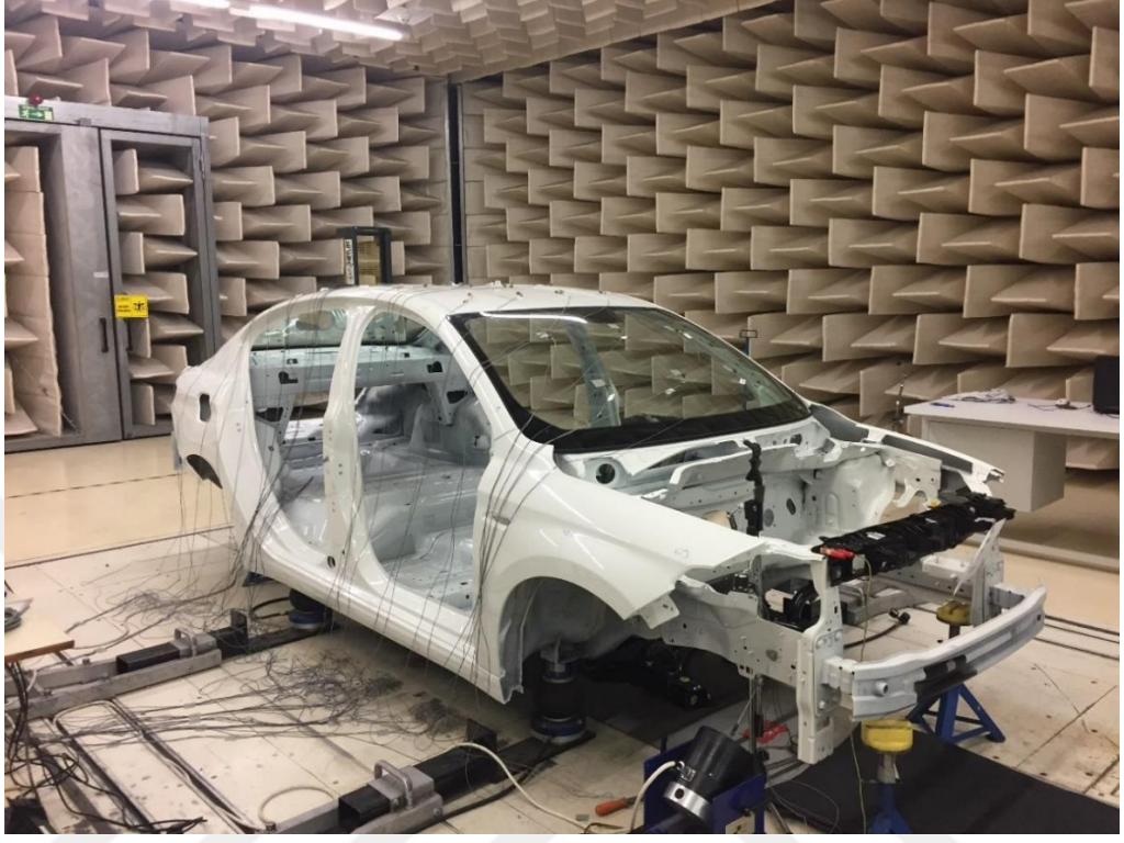
Şekil 3.10. Titreşim seviyesi ölçümü için hazırlanmış araç
