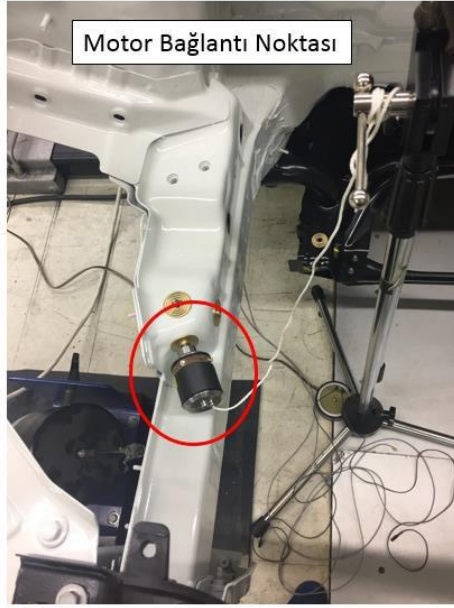
Şekil 3.11. Motor ve Şanzıman gövde bağlantı bölgesine takılacak titreşim motorları
