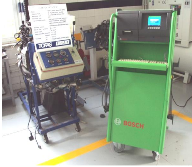
Şekil 3.9. Deneylerde kullanılan egzoz emisyon ölçüm cihazı (Erkuş, 2011)
