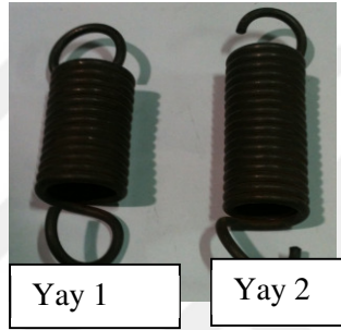
Şekil 4.5. Koltuk süspansiyon sisteminin yayları
