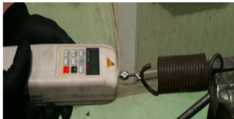
Şekil 4.6. Yay rijitlik katsayısının tayini
