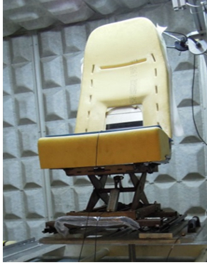
Şekil 4.4. Pasif süspansiyonlu prototip koltuk
