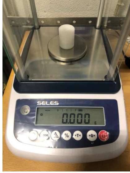
Şekil 6.12 Ağırlık kaybı ölçümlerinin yapıldığı hassas ölçüm cihazı
