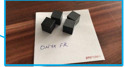
Şekil 6.7 Markforged® X7 ONYX-FR Numune Üretimi (PROMAKİM)
