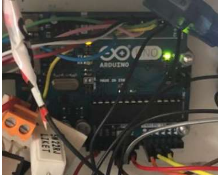
Şekil 3.14. Güneş takip sisteminde kullanılan Arduino Uno.
