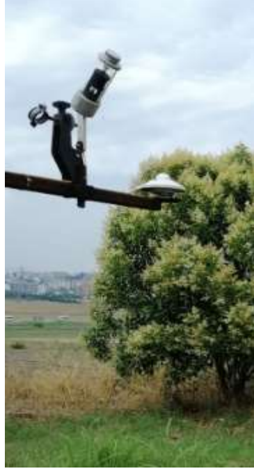
Şekil 3.5. Çalışmada kullanılan güneş takip sistemine ilişkin piranometre cihazı.
