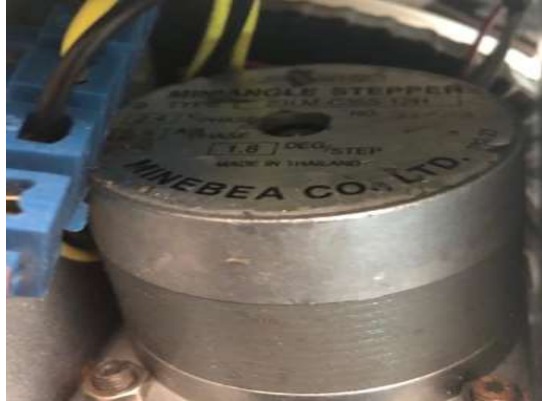
Şekil 3.6. Güneş takip sisteminde kullanılan step motor.
