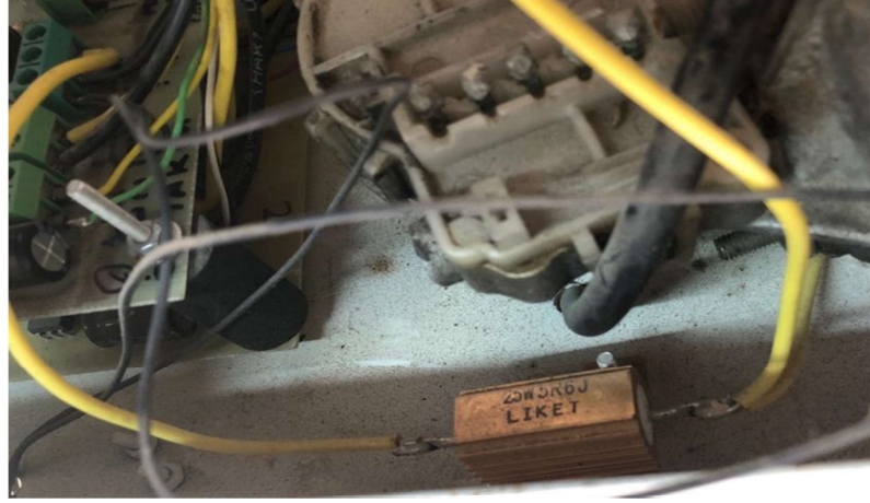
Şekil 3.15. Sistemde kullanılan 25W5R6J direnç.
