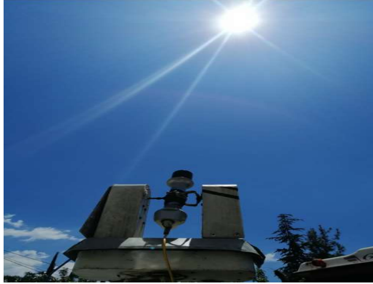
Şekil 3.1. Çalışmada kullanılan güneş takip cihazı ve pirheliyometre.
