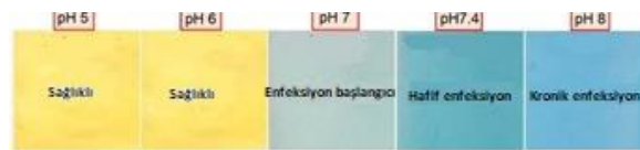
Şekil 2.28. İki katmanlı bromotimol mavisi içeren lif esaslı sistemin farklı pH’lardaki durumu (Bazbouz ve Tronci 2019)
