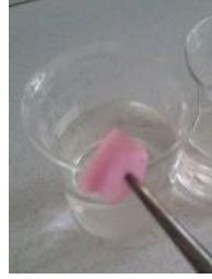
Şekil 4.36. 2 nolu çapraz bağlama çözeltisinde 1 saat bekletildikten sonra etil alkol ile 5 dakika yıkanan nanolifli yüzey numunesi
