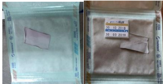
Şekil 3.29. Sterilizasyon öncesi (solda) ve sterilizasyon sonrası (sağda) PVA/NaAlg/Mor lahanananolifli yüzey
