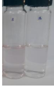
Şekil 4.38. İçerisinde nanolifli yüzey numunelerinin 1 saat bekletildiği 2 nolu (sağda) ve 3 nolu (solda) çapraz bağlama çözeltileri
